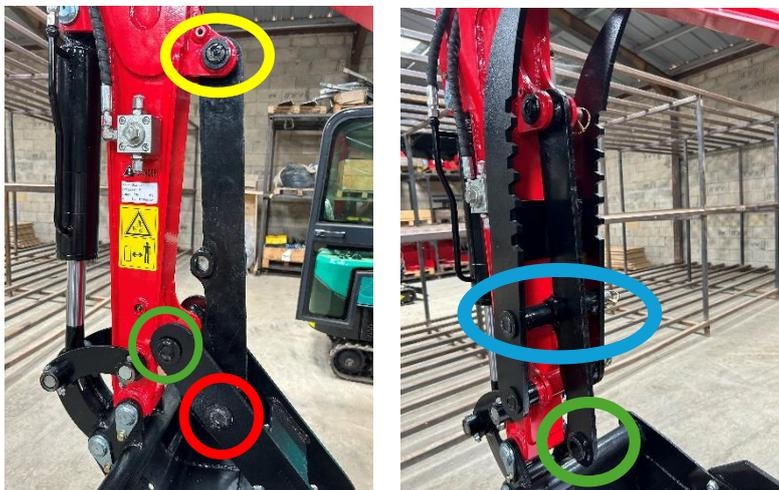
Le doigt de manutention peut aussi être stocké le long du bras. Pour ce, il faut retirer l'axe (entouré en vert, image de droite) qui fixe le doigt à la barre de réglage et insérer l'axe dans le trou supérieur de la barre de réglage (entouré en bleu).
