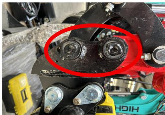
Pour attacher votre godet, insérer un axe dans les trous avant du godet, puis accrocher l'axe sur l'attache semi-rapide (entouré en vert) et puis passer un axe dans le trou qui se situe derrière.
