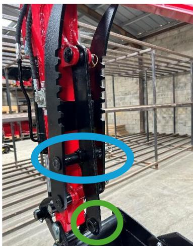
Le doigt de manutention peut aussi être stocké le long du bras. Pour ce, il faut retirer l'axe (entouré en vert, image de droite) qui fixe le doigt à la barre de réglage et insérer l'axe dans le trou supérieur de la barre de réglage (entouré en bleu).
