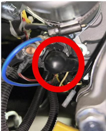
Pendant que le moteur est arrêté, mais encore chaud, débrancher le câble de la bougie (entouré en rouge) et le tenir à l'écart de la bougie.
