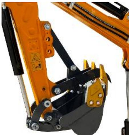
La hauteur de la barre de réglage peut être changée, en baissant le point de fixation de la barre de réglage. Cela va baisser le doigt de manutention.
