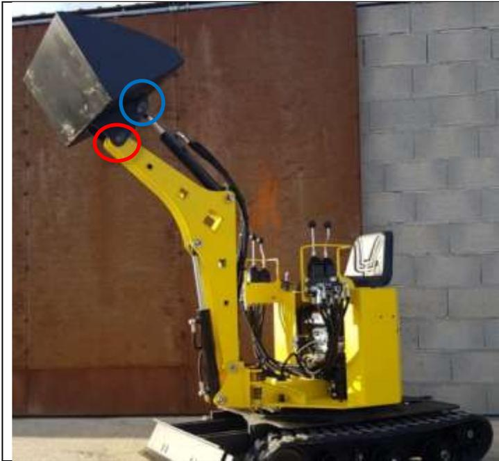
Aligner le perçage du godet du bas avec le perçage du bras de levé (en rouge) puis passer l'axe dans le perçage.
