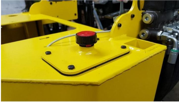
Remplir le réservoir d'huile hydraulique et monter la plaque réservoir avec 4 vis (le niveau sera à refaire après le premier démarrage).
