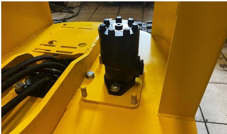
Monter le moteur hydraulique sur la tourelle puis le visser avec des écrous de M14 frein.
