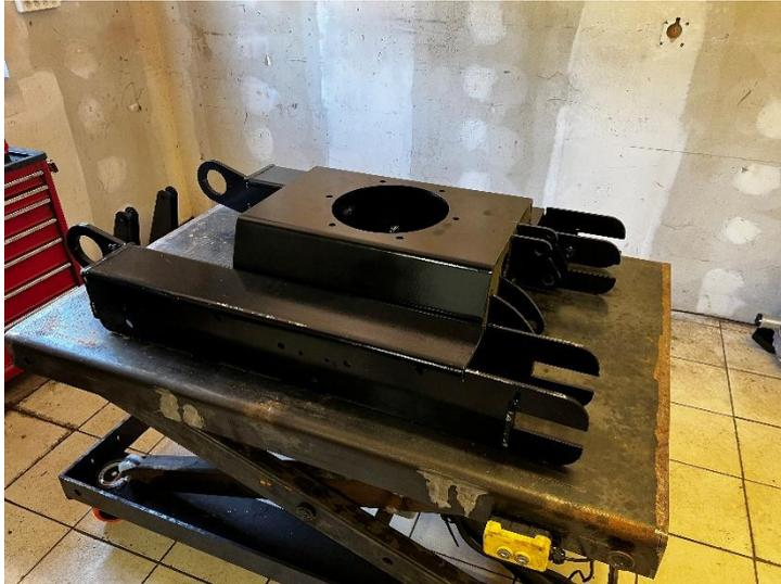
Monter les 3 parties du chassis ensemble avec 4 vis de 16x50 et ecrou frein par coté.
