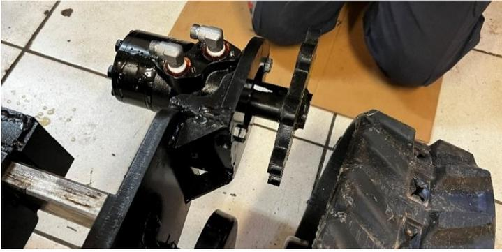
Faites un montage a blanc des entrainements de chenilles en graissant légèrement l'axe moteur pour faciliter le montage.
