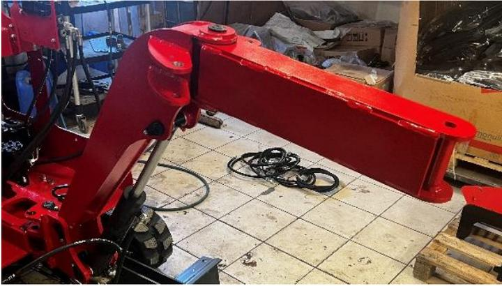
Monter un graisseur M6 de chaque côté du noyau.
