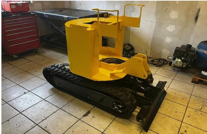
Monter la tourelle sur le châssis, en faisant passer les flexibles au centre de la tourelle.
