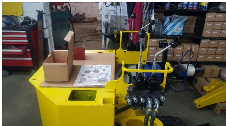
Connecter les flexibles déjà monter au distributeur en suivant le plan de branchement
