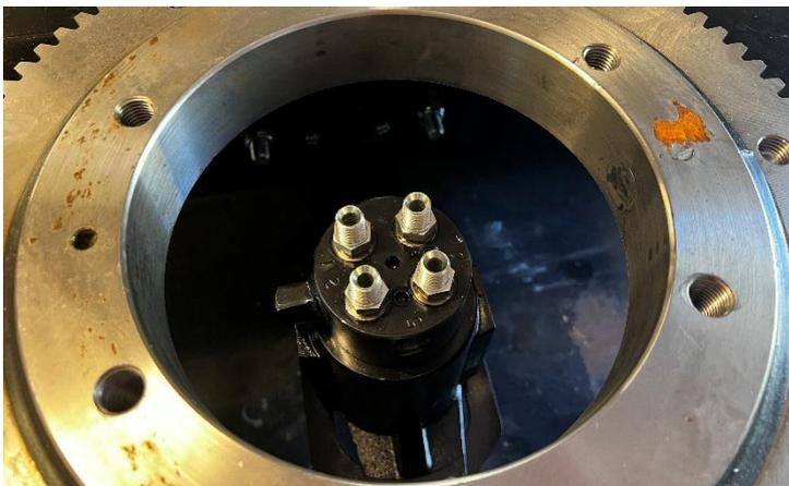
Monter les raccords sur le joint tournant si ceux-ci ont un joint pas besoin de téflon, sinon mettre du téflon sur ceux-ci.
