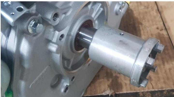
Remonter la clavette sur l'arbre moteur puis emboîter l'accouplement coté moteur en buté sur l'arbre moteur.
