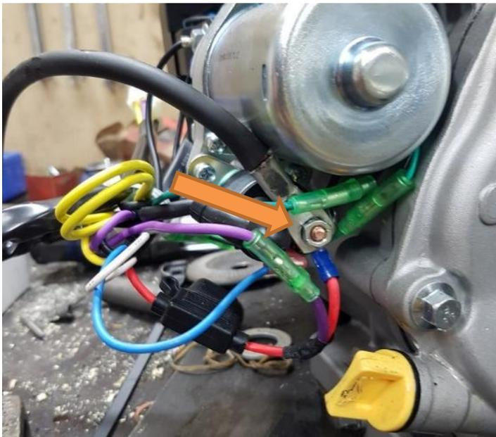
Brancher le + à l'arrière de la bobine sur le câble rouge déjà connecté.
