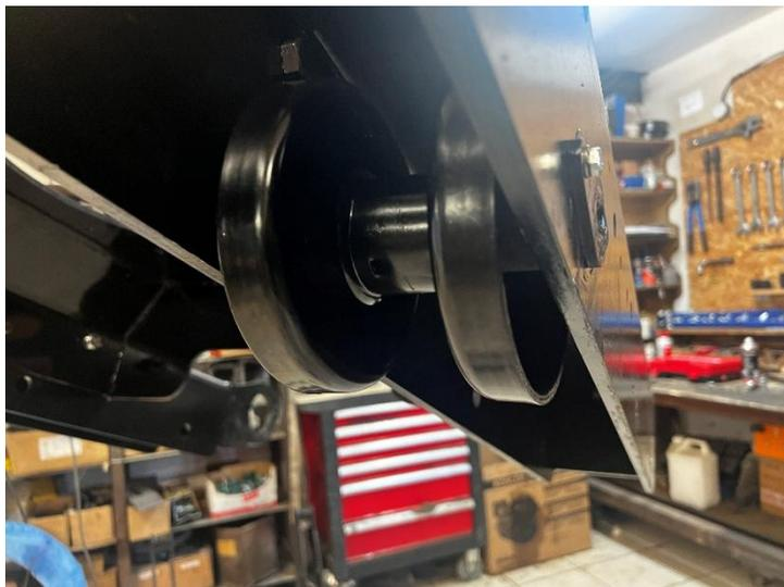
Mettre en place les 6 rollers  $\varnothing 160 - 25$  avec 4 axes  $\varnothing 25$  lg 175 + goutte d'eau dans les 2 côtés des trains de chenilles.
