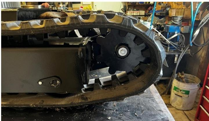
Verrouiller les barbotins avec une vis de 8x50 TH et une rondelle en 8x30 + une goutte de frein filet.
