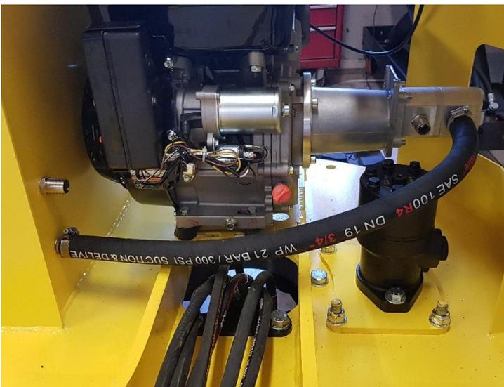
Brancher les 2 flexibles d'alimentation de la pompe puis les verrouiller avec un collier de chaque côté.
