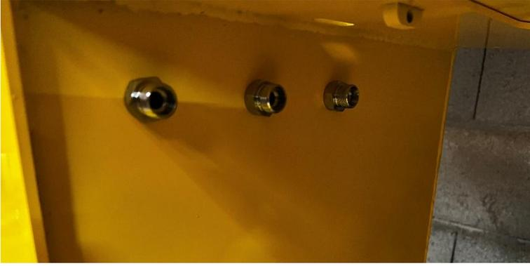
Monter les raccords union sur les retours réservoir en passe cloison avec une bague BS17 + écrou 3/8 dans le réservoir.
