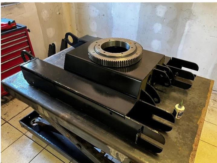
Monter la couronne sur le châssis avec 6 vis M16x50 + un peu de frein filet
