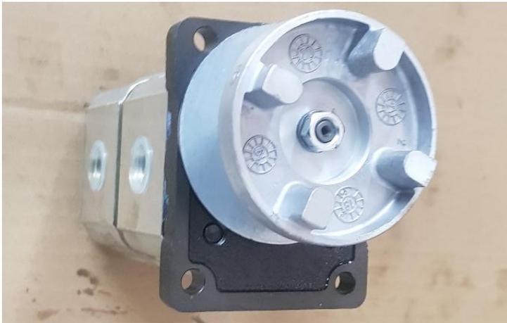
Emboiter le demi-accouplement en faisant bien attention à ce que la clavette ne se retire pas du cône de l'arbre.
