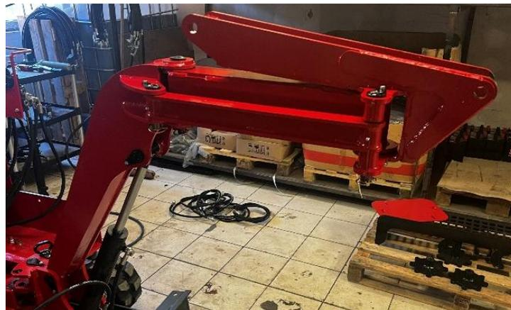
Monter 2 graisseurs M6 sur le renvoi puis monter le renvoi du bras avec 2 axes, 1 axe Ø25 lg 210+GE et un axe Ø25 lg 100+GE.
