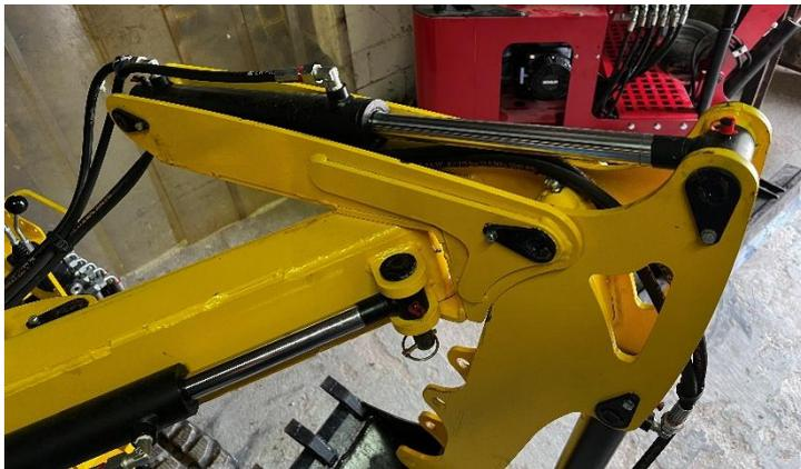
Monter des coudes CM12L-12x17 sur les vérins du godet, du balancier et du vérin de déport avec un peu de téflon.
