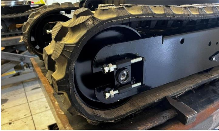
Monter les tendeurs sur l'avant des chenilles avec 2 vis de 12x100 + écrou de verrouillage.
