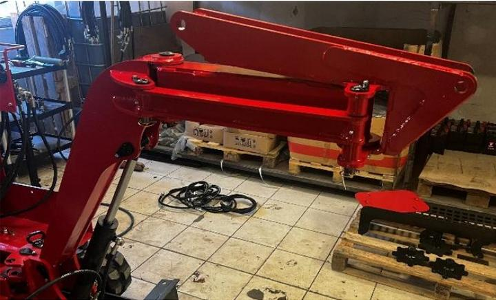
Monter le nez de bras avec un axe pivot de Ø25 lg 210 avec rondelle + goupille.
