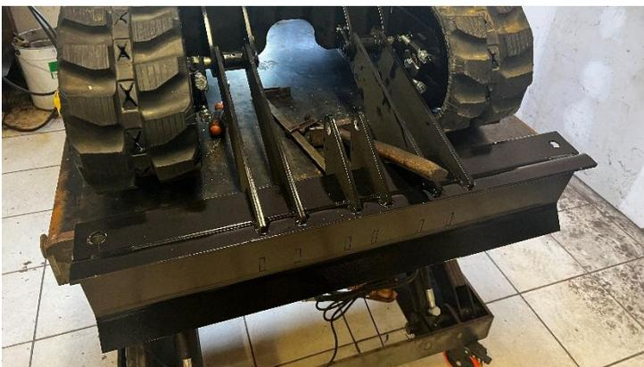
Monter la lame sur le châssis avec 2 axes  $\varnothing 25$  lg 90 – goutte d'eau.
