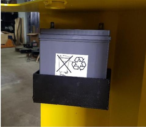
Avant de monter le moteur dans le châssis, mettre le support batterie et la batterie en place.
