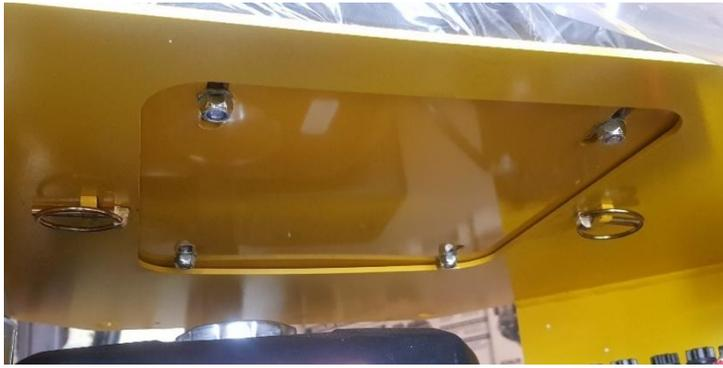
Monter le siège a travers les mortaise présente sur la tourelle et mettre 2 goupilles pour le maintenir en place.
