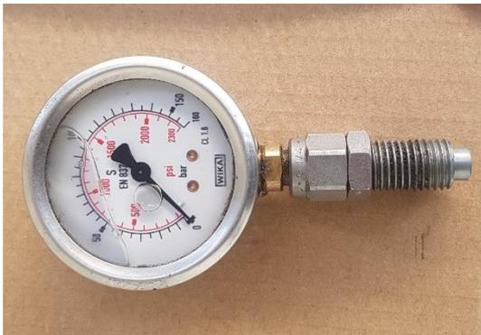
Monter le raccord 1/4 femelle sur le manomètre.
