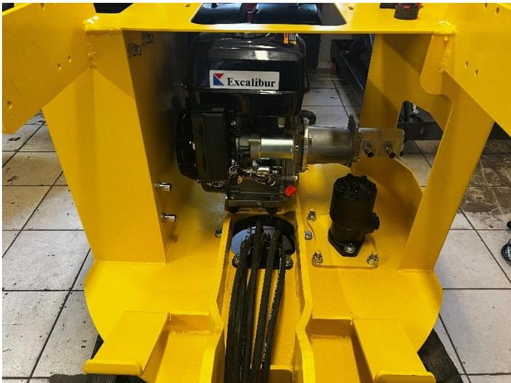
Positionner le moteur thermique sur les silentblocs puis visser le avec des vis de 8x35 + rondelle 8x30 coté trou oblong et M8 sur les perçages classiques.
