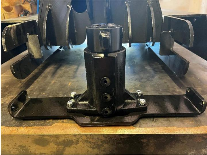
Monter le joint tournant sur sa plaque de fixation avec 4 vis de 8x30 BTR + écrou frein
