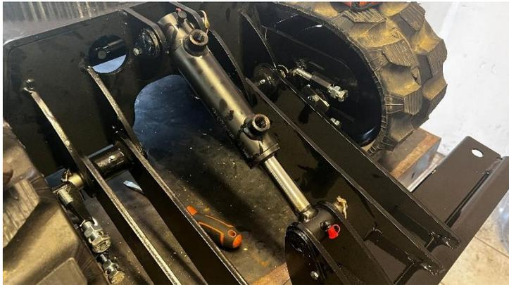
Monter le vérin de lame sur le châssis puis sur la lame avec 2 axes  $\varnothing 20$  lg 90 + GE.
