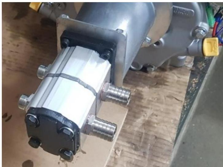
Monter les raccords sur la pompe, 2 raccords UM12L-12x17 coté pression 2 raccords cannelé EC19MC3/8 coté aspiration avec 2 rondelles cuivre Ø17 pour l'étanchéité.
