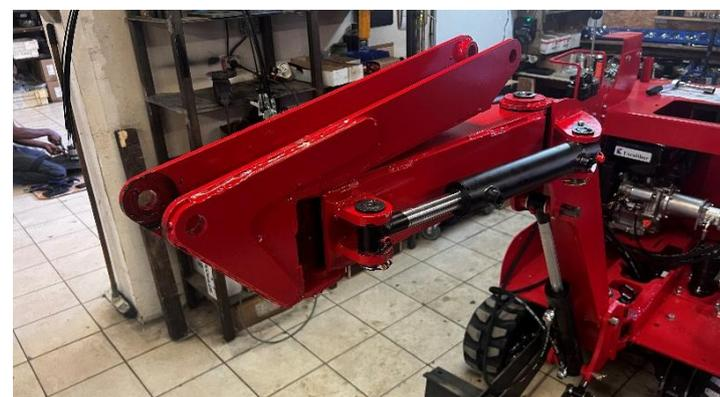
Monter le vérin de déport, raccords vers l'extérieur avec un axe Ø25 lg 110 rondelle pour la tête et un axe Ø25 lg 110 avec goutte d'eau au cul.
