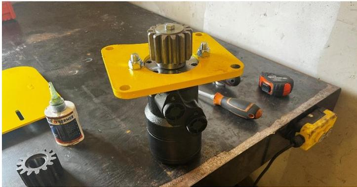
Monter le pignon de la tourelle sur le moteur hydraulique déport vers le moteur.
