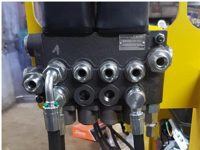
Monter les raccords sur les distributeurs hydraulique
