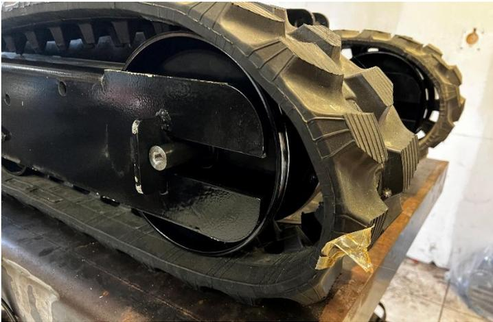
Soulever légèrement le châssis pour faciliter le montage.
