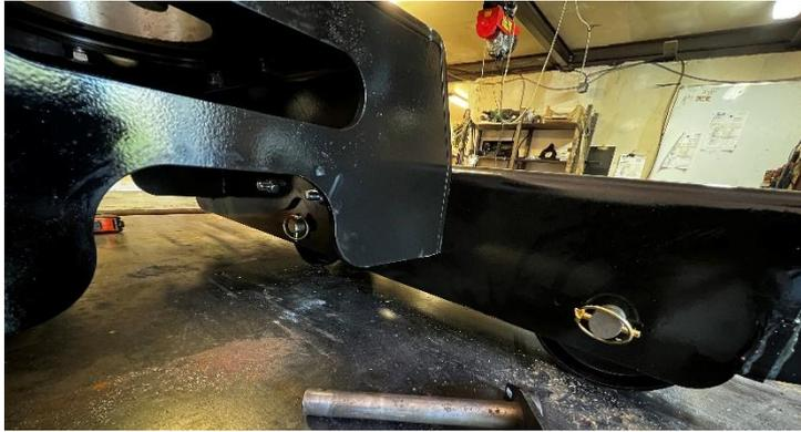
Mettre les goupilles de verrouillage sur les axes.
