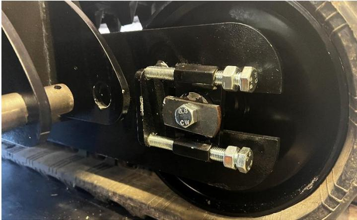
Verrouiller les tendeurs avec des rondelles épaisse de 12x30 + vis M12x30 + une goutte de frein filet.
