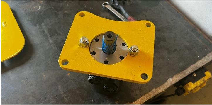
Monter le moteur hydraulique de la tourelle sur la plaque de rotation moteur.
