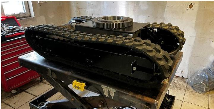
Monter le barbotin sur le moteur hydraulique en faisant attention à ne pas faire tomber la clavette.
