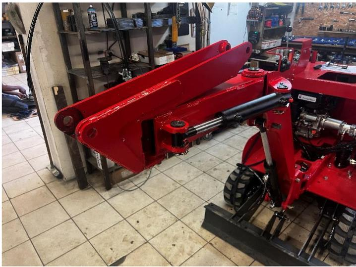
Monter le vérin de départ, raccords vers l'extérieur avec un axe  $\varnothing 25$  lg 110 rondelle pour la tête et un axe  $\varnothing 25$  lg 110 avec goutte d'eau au cul.
