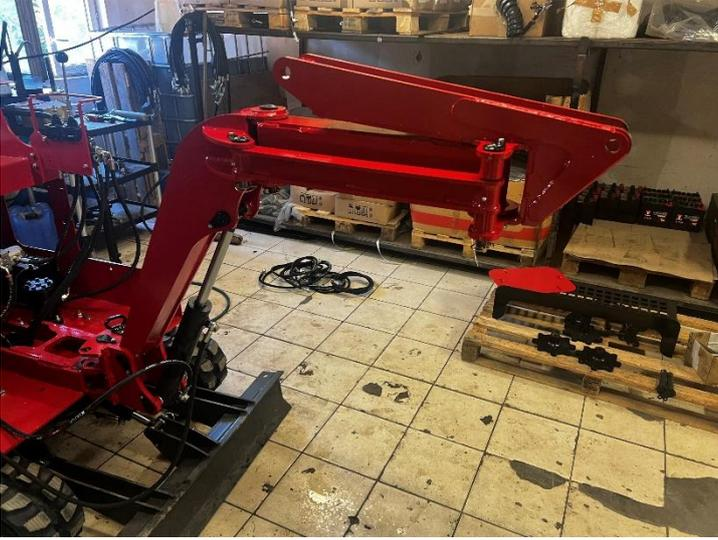
Monter 2 graisseurs M6 sur le renvoi puis monter le renvoi du bras avec 2 axes, 1 axe  $\varnothing 25$  lg 210 goutte d'eau et un axe  $\varnothing 25$  100 goutte d'eau.
