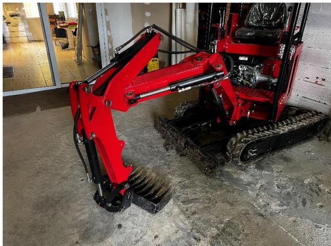
Le bras déportable se monte en lieu et place du bras de levée d'origine, aucune modification ne sera nécessaire pour le montage de celui-ci.
