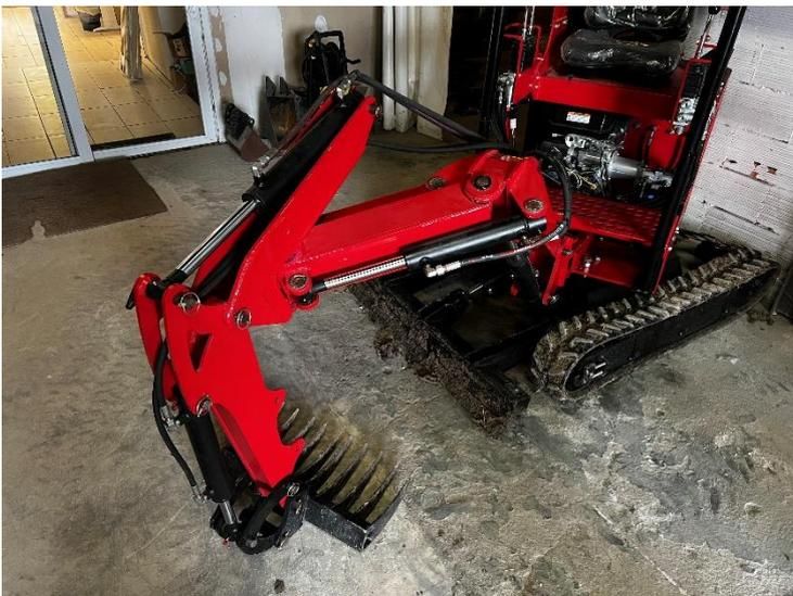
Pour finir le montage il ne vous restera qu'à connecter le flexible de ligne auxiliaire sur le vérin afin d'alimenter le vérin.
