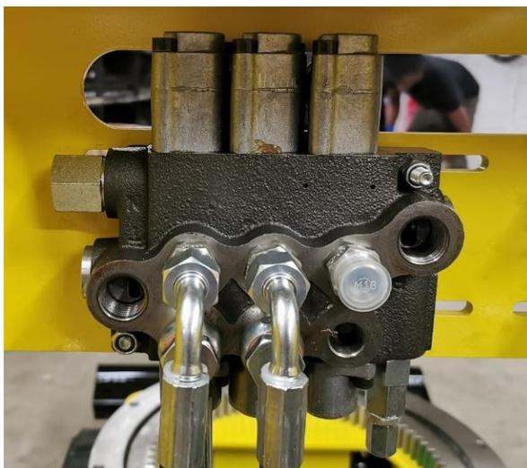
Monter le Carry over sur le distributeur 3 éléments
