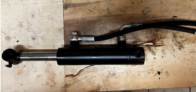
Monter les flexibles sur les 2 vérins de la lame.
