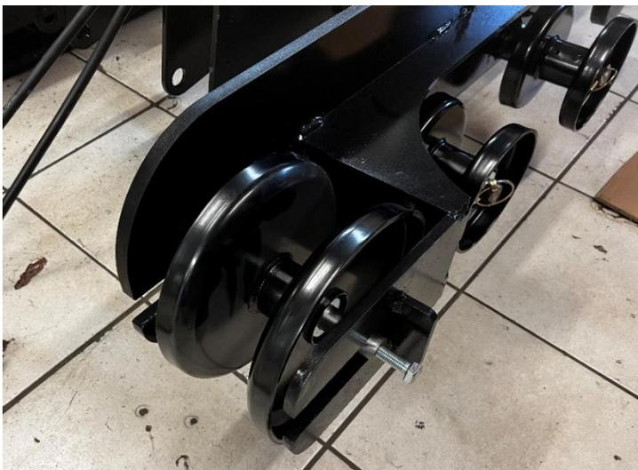
Placer le roller + axe dans le châssis, sans les demi-tendeur pour le moment.
