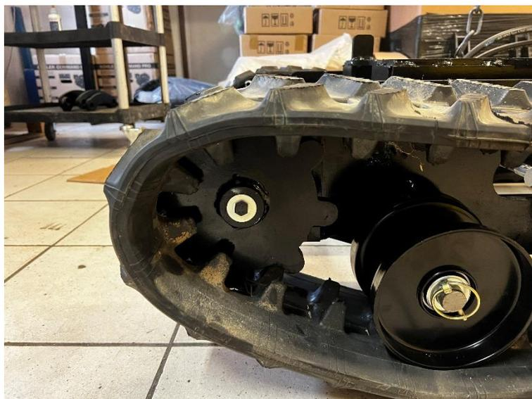
Monter une vis 8x50 + 1 rondelle Ø8x40
