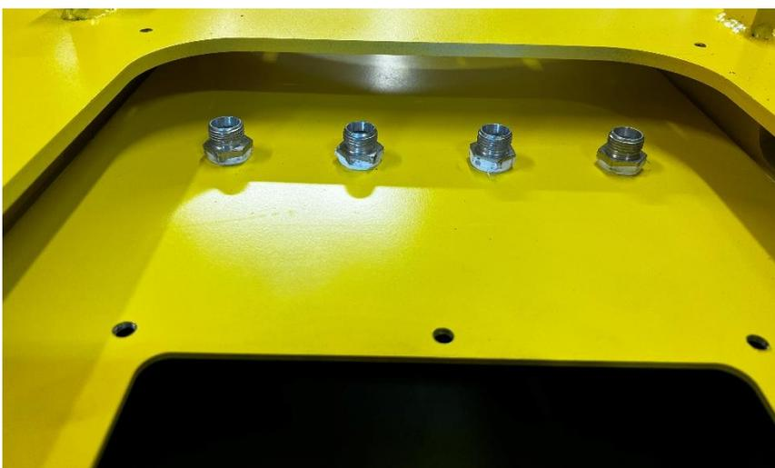
Monter les raccords union sur le réservoir avec les écrous 12L + rondelle dans le réservoir
