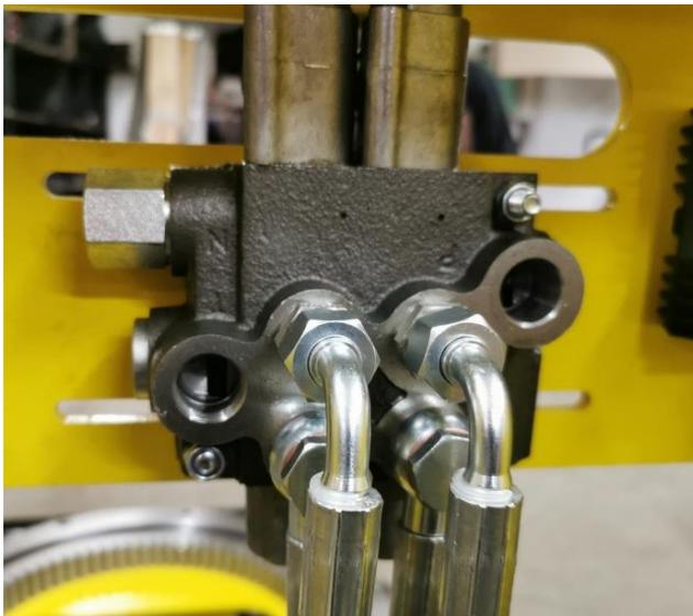
Monter le Carry over sur le distributeur 2 éléments
