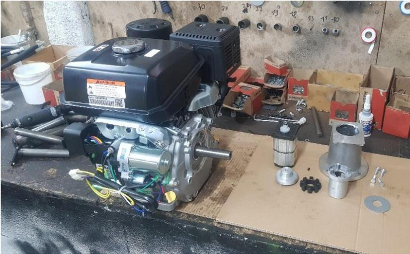
Faire le niveau d'huile dans le moteur thermique, remplir par un des 2 bouchons présents de chaque côté du moteur.
