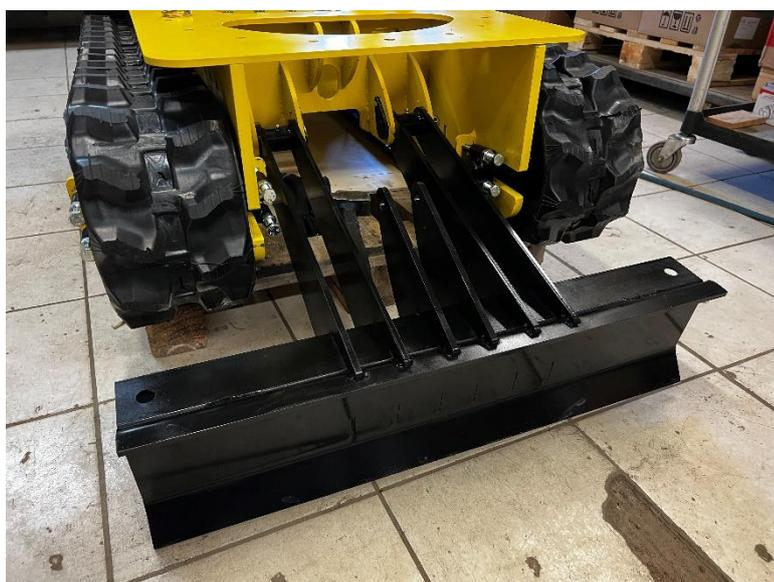
Monter la lame dans le châssis.
