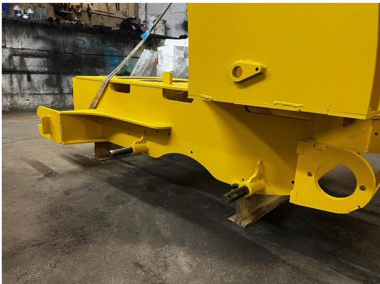
Monter les axes dans le châssis, puis les verrouiller sous le châssis.
