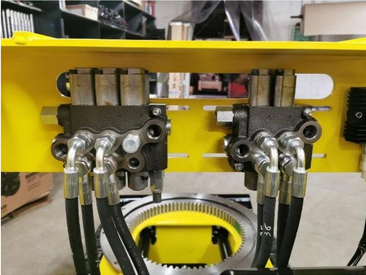
Monter les distributeurs sur la partie chargeur.
