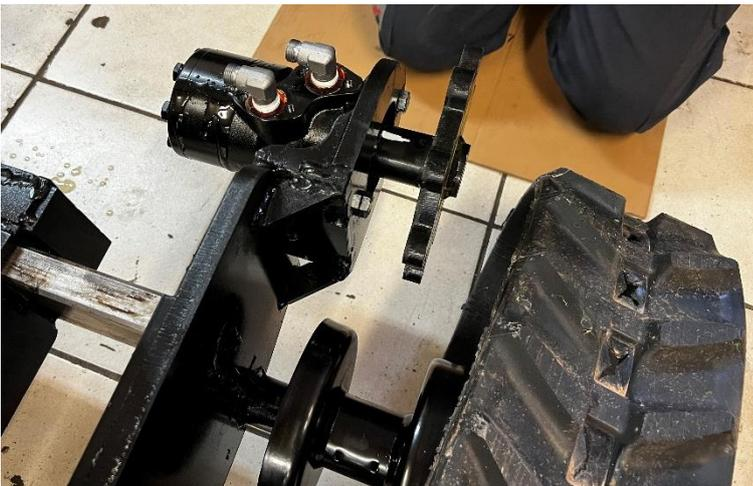
Monter le barbotin sur le moteur hydraulique, faites tourner le moteur hydraulique à la main puis re-démonter le barbotin.
