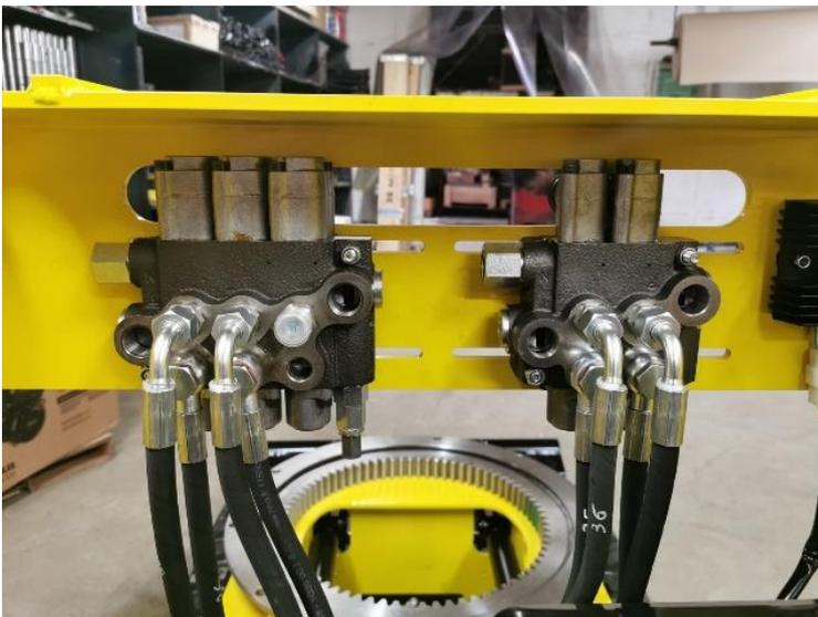
Brancher les flexibles déjà monté sur les distributeurs, moteurs hydrauliques et lame notamment.
