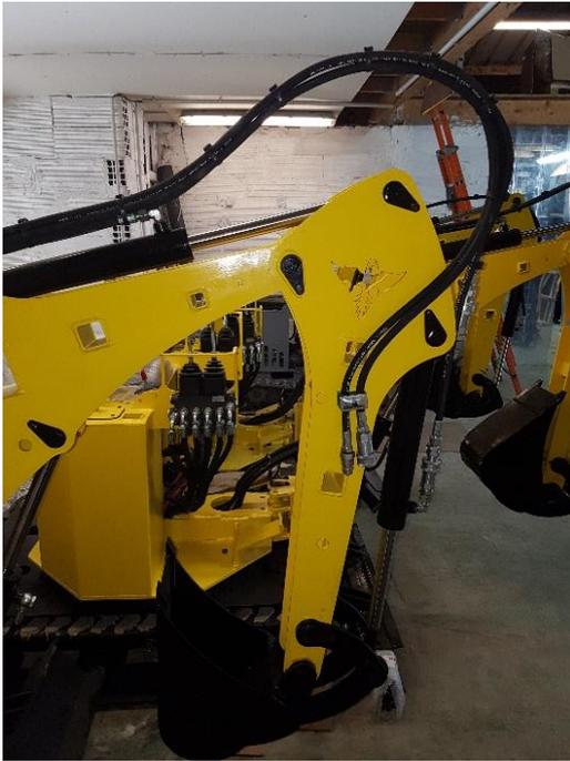
Ligne hydraulique supplémentaire en bout de flèche, ce sont 2 flexibles tiré depuis le distributeur gauche, remplaçant le bypass des flexibles 15-16 jusqu'au bras de balancier.
