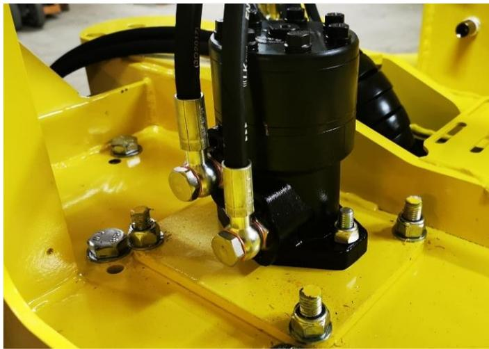
Positionner le moteur hydraulique, faites attention à ce que la dentelure soit bien enclenchée.
