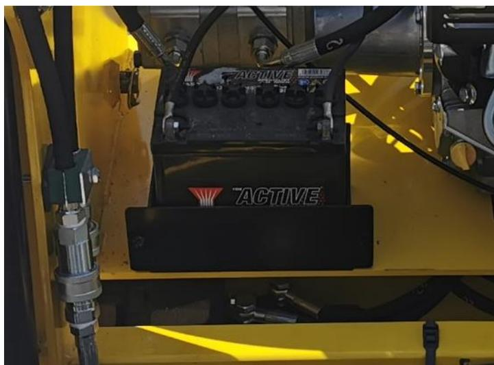
Monter la batterie sur le châssis.
