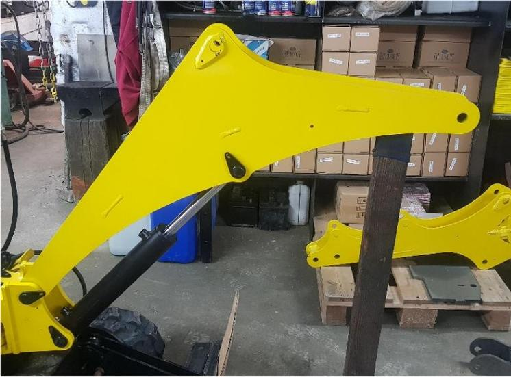
Monter le bras de levée et le vérin de 30/60 c 300 avec les raccords orientés vers le haut.
