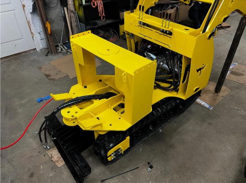
Monter la tourelle sur le châssis.
