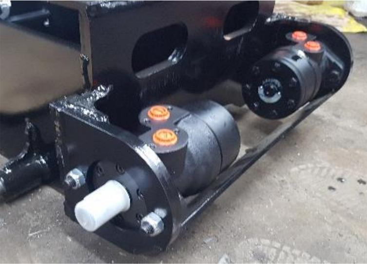
Monter 2 moteurs hydrauliques **OMR 200** sur le châssis avec 2 vis M12x50 et 2 écrous frein par moteur.
