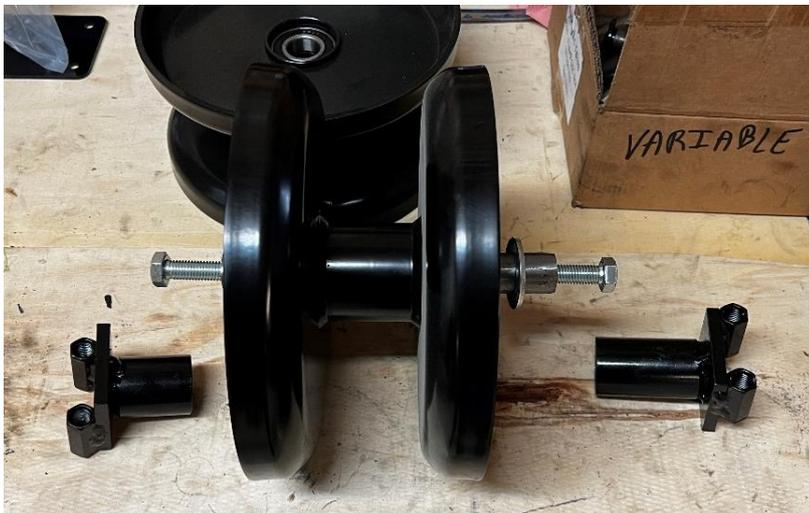
Passer l'axe avec double taraudage dans le roller Ø240 avec une rondelle de chaque côté.
