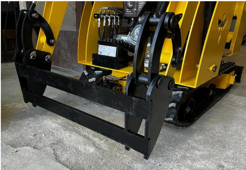
Monter le tablier sur la partie chargeur, celui-ci sera légèrement vrillé de par sa nature, il sera donc nécessaire de le faire tirer à l'aide de serre joint.
