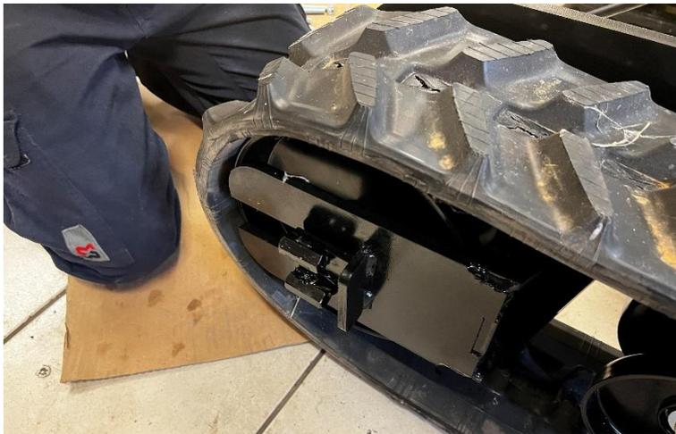
Monter le second demi-tendeur (court) depuis l'extérieur du châssis puis verrouiller avec une vis 12x30 BTR.
