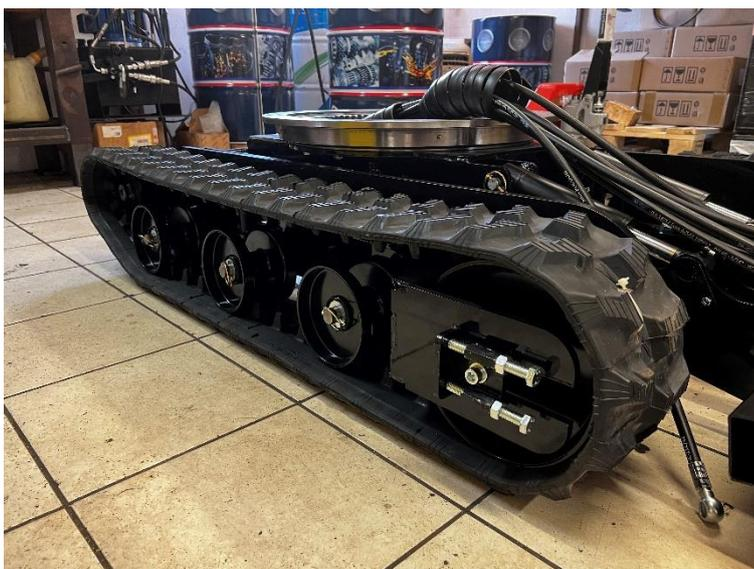
Monter les Vis tendeur 12x100 avec un contre écrou, 2 par coté.
