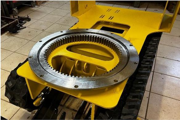
Monter la couronne d'orientation sur le châssis.
