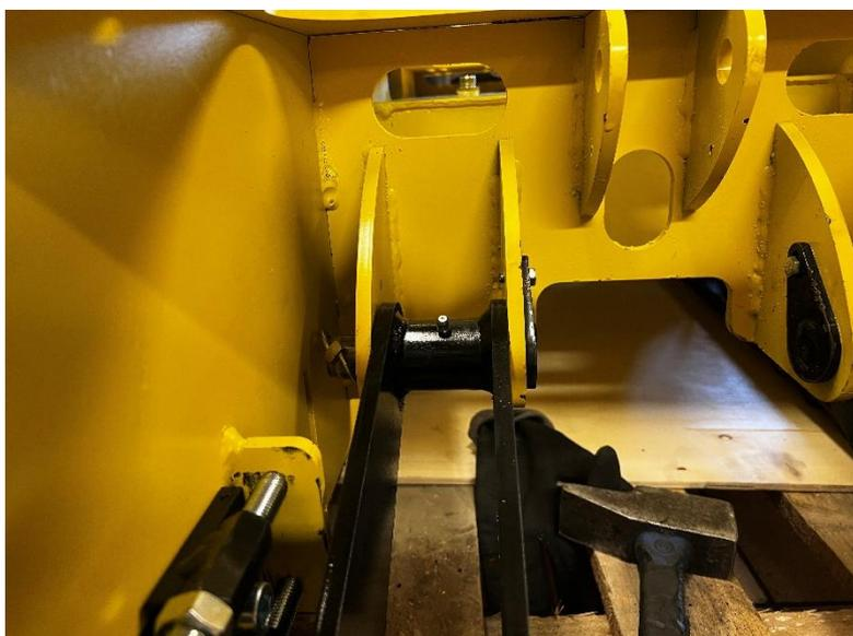
Monter les graisseurs sur la lame
