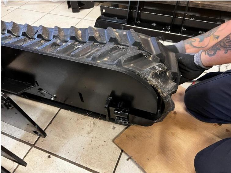
Monter le demi-tendeur (long) depuis l'intérieur, puis verrouiller avec une vis 12x30 BTR.
