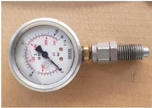
Monter le raccord ¼ femelle sur le manomètre.
