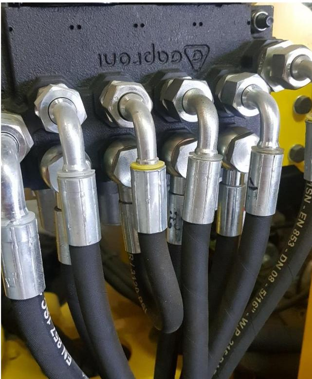
La ligne 15-16 n'est pas utilisée de série, celle-ci est obstruée avec un court flexible mit en bypass.
