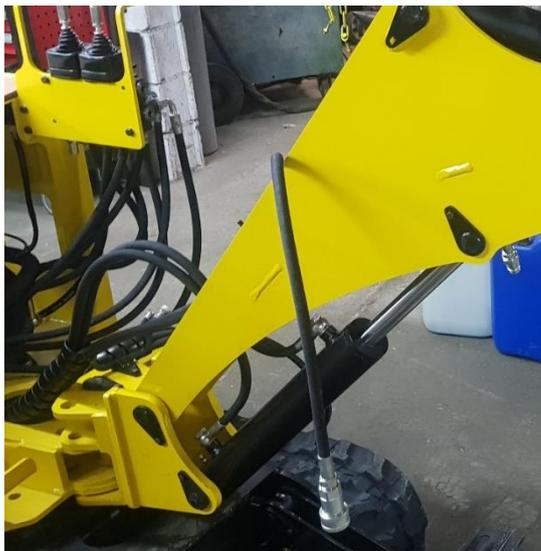
Pour faciliter l'assemblage, monter les flexibles en partant toujours du distributeur pour aller au vérin.
