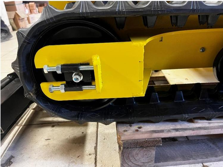
Monter les Vis tenseur 12x100 avec un contre écrou, 2 par coté.
