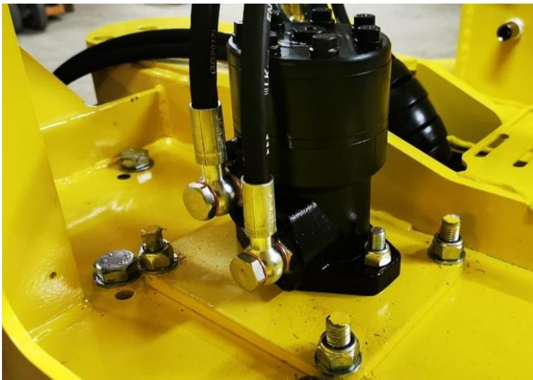
Positionner le moteur hydraulique, faites attention à ce que la dentelure soit bien enclencher.
