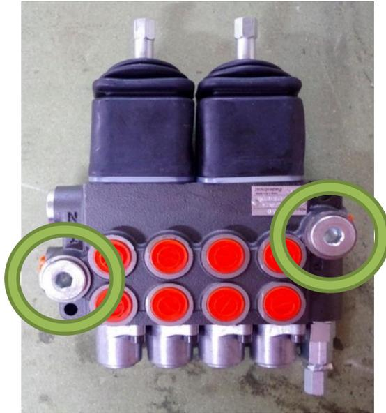
Sur la face avant des distributeurs, démonter les bouchons en acier qui sont en façade puis les remonter sur les côtés du distributeur à la place des bouchons plastique rouge.
