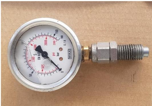
Monter le raccord  $\frac{1}{4}$  femelle sur le manomètre.
