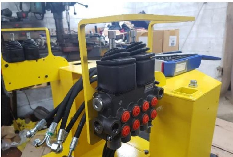
Monter les 2 distributeurs hydraulique.
