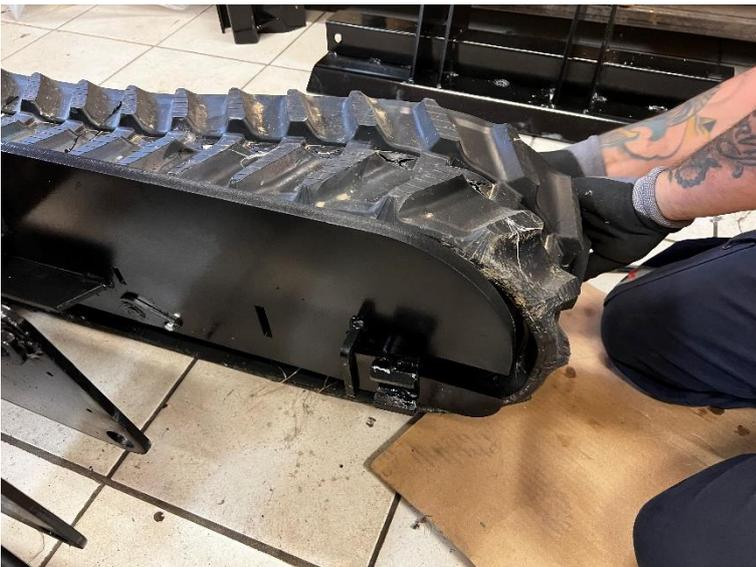
Monter le demi-tendeur depuis l'intérieur, puis verrouiller avec une vis 12x30 BTR
