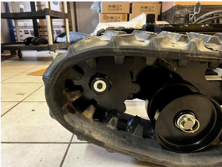
Monter une vis 8x50 + 1 rondelle  $\varnothing$ 8x40 avec un **léger** point de colle pour éviter que celui-ci ne se desserre facilement à l'usage
