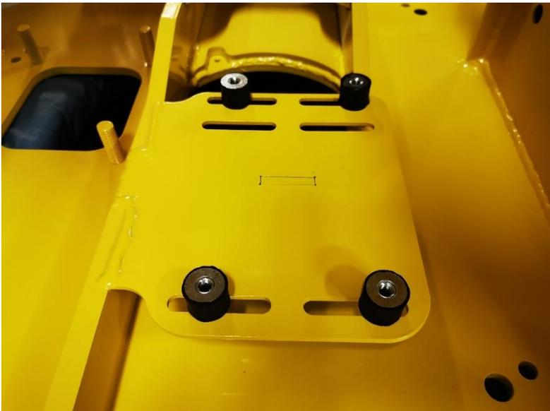
Monter les 4 silentbloc avec 1 rondelle
