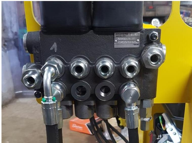
Monter les raccords sur les distributeurs hydraulique
