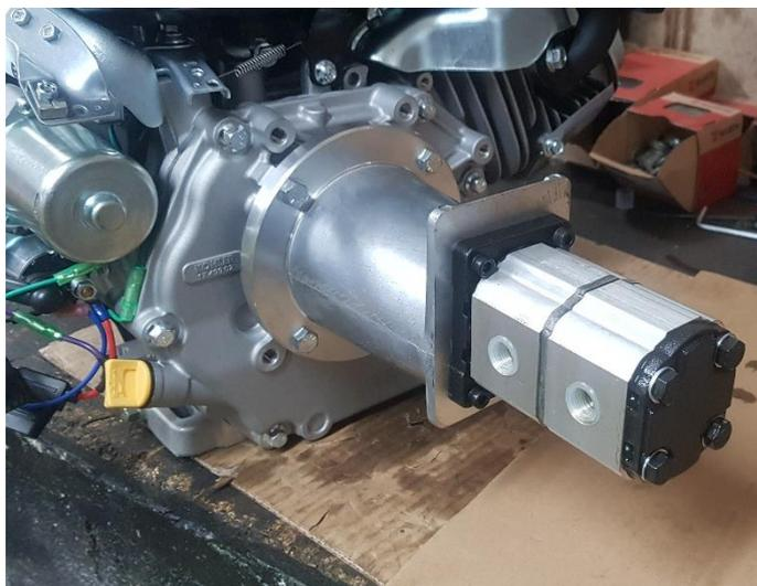
Placer la pompe sur la lanterne avec les 4 vis BTR de 6x25 coller une des vis afin que l'ensemble ne se desserre pas avec les vibrations.
