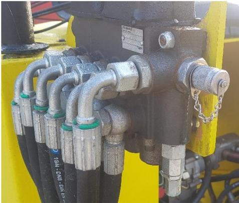
Monter le raccord male  $\frac{1}{2}$  sur le distributeur.
