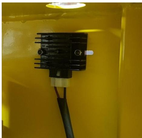
Monter le régulateur de charge sur le châssis, gratter la peinture pour que celui-ci soit connecté à la masse sur le châssis.
