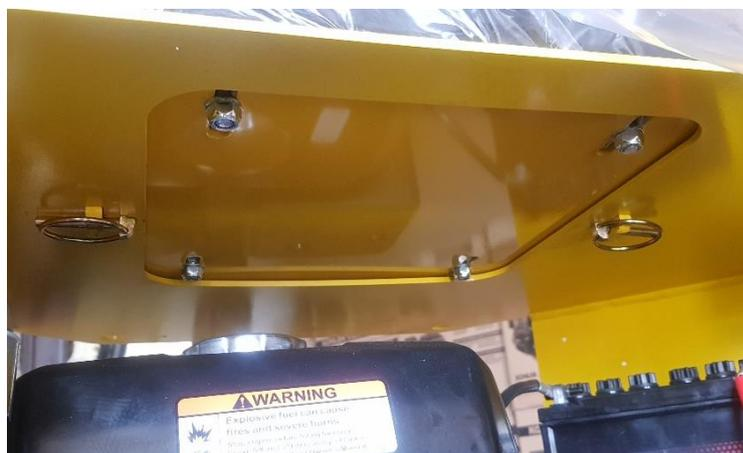
Monter le siège a travers les mortaise présente sur la tourelle et mettre 2 goupilles pour le maintenir en place.
