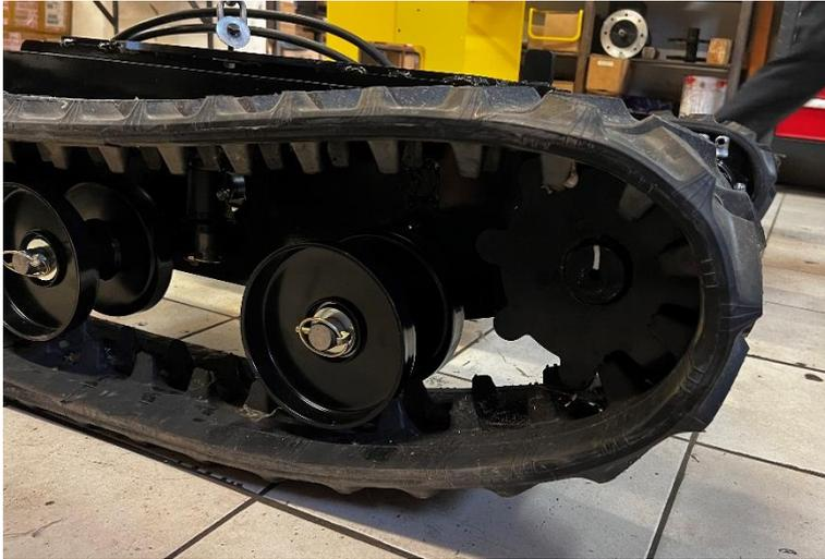
Placer le barbotin dans la chenille puis enclencher celui-ci sur le moteur hydraulique.
