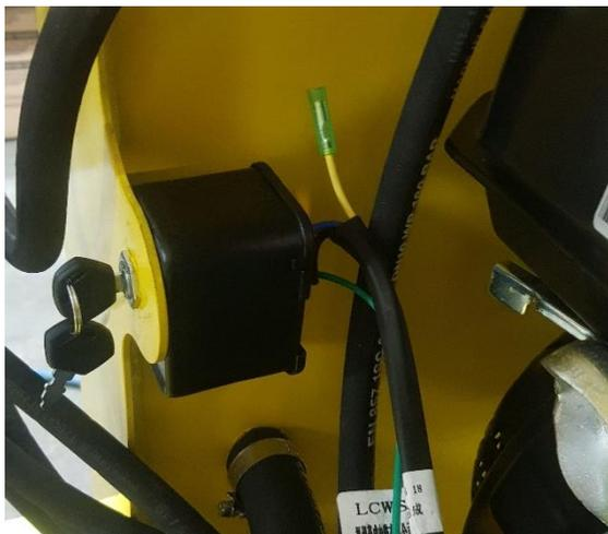
Démonter le contacteur à clé du moteur, couper les 2 pattes de fixation et le visser en passe cloison sur le trou en façade du carter.
