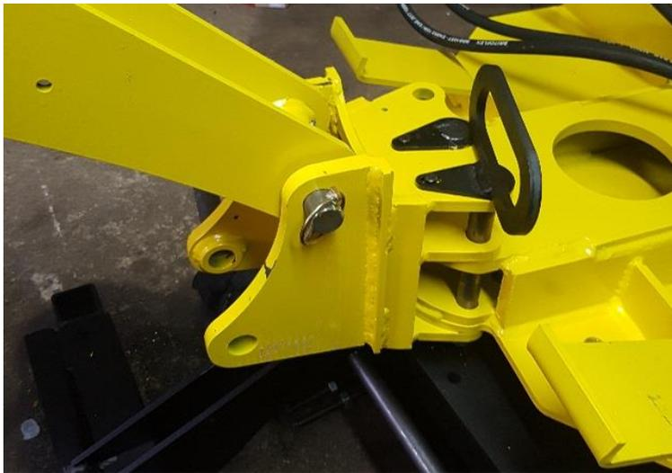
Monter la noix avec un axe Ø25 lg 210 au centre et un axe Ø25 lg 210 avec poignée sur l'un des côtés.
