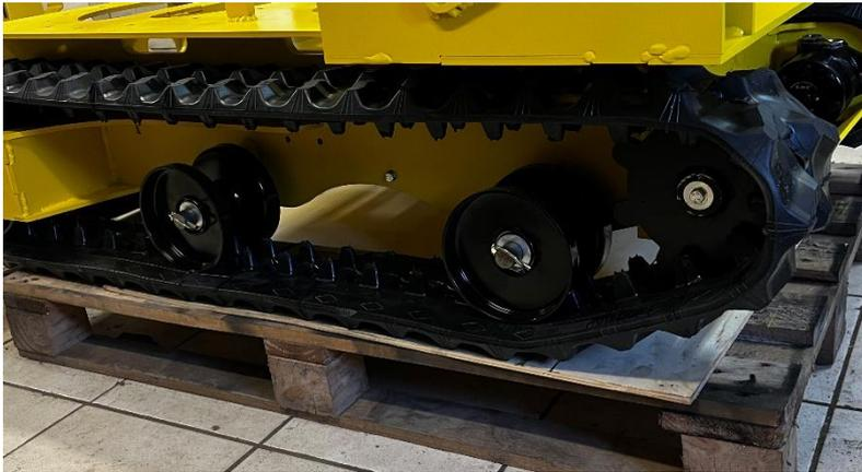
Monter les Rollers  $\varnothing 160 - 25$  sur les 4 axes du châssis
