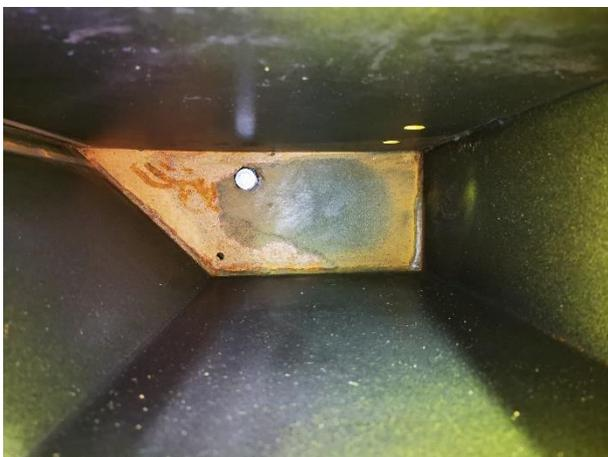
Monter le boulon 18x50 avec rondelle cuivre et ruban téflon dans le fond du réservoir, verrouiller fortement le boulons pour éviter les fuites.
