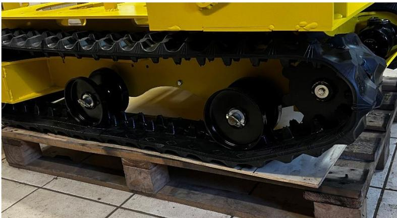
Mettre 2 rondelles  $\varnothing 25$  sur chaque roller avant de placer la goupille.
