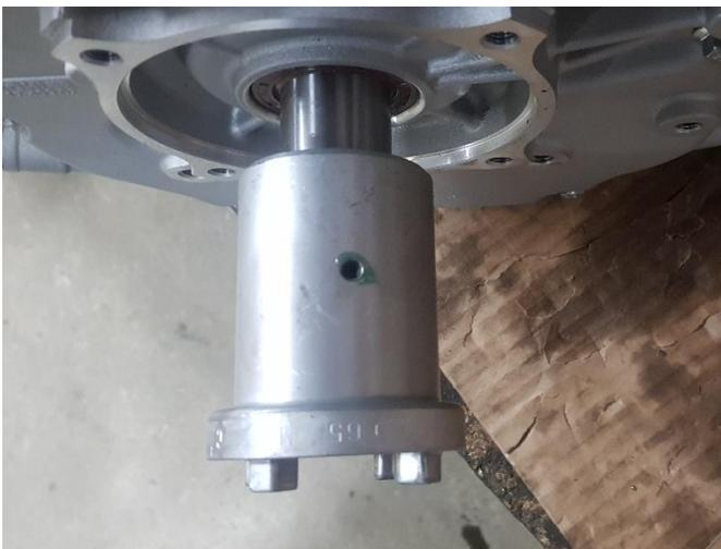
Monter la vis de blocage sans tête en la collant avec du frein filet.
