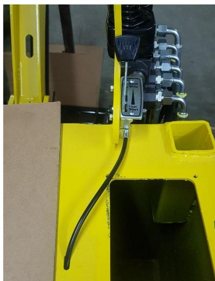
Monter l'accélérateur sur le support distributeur droit et faire passer la gaine dans le trou oblong à côté du réservoir.
