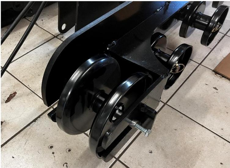
Placer le roller dans le tendeur (l'axe fait 25, la rainure 40, cela est normal).
