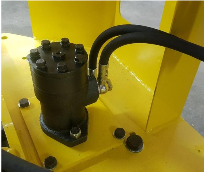
Monter les réductions (avec téflon) puis les flexibles sur le moteur hydraulique jusqu'au distributeur.
