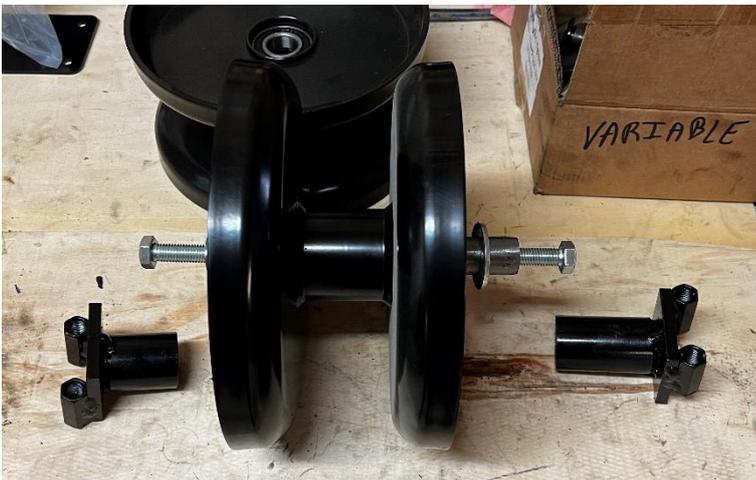
Prémonter les rollers « tendeur »
