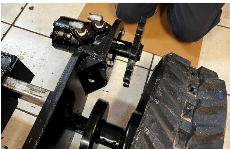
Monter le barbotin sur le moteur hydraulique, faites tourner moteur hydraulique à la main puis re-démonter le barbotin.
