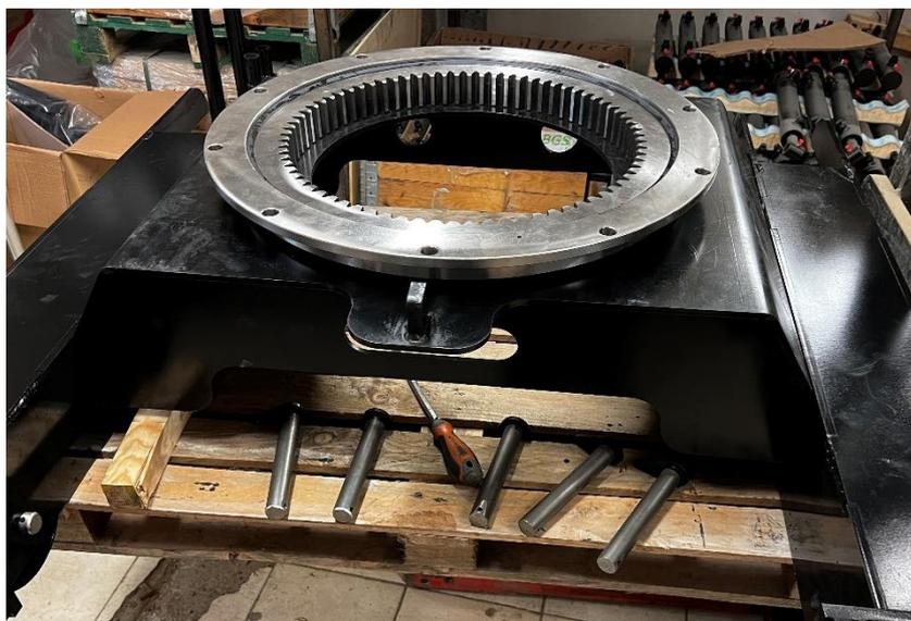
Monter la couronne d'orientation sur le châssis.
