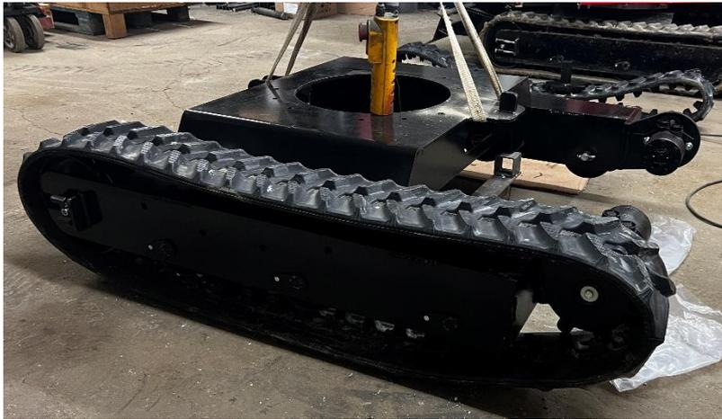
Soulever un coté du châssis ou le châssis complet en fonction des moyens à disposition puis positionner les chenilles.
