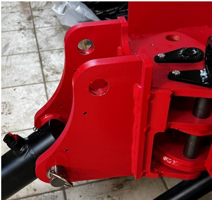
Monter la noix avec un axe  $\varnothing 25$  lg 210 au centre et un axe  $\varnothing 25$  lg 210 avec poignée sur l'un des côtés.
