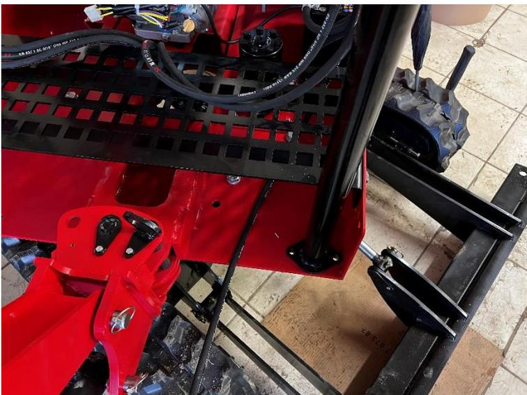
Monter les potences avant, boulonner avec des vis 12x40 + écrou
