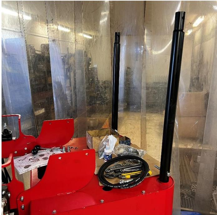
Monter les potences arrières, emboîter et verrouiller avec des vis de 12x80 + écrou.
