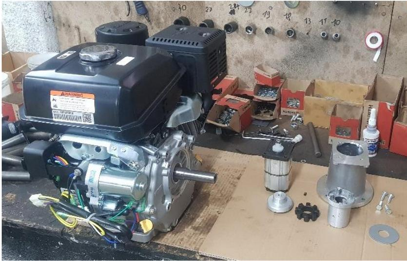
Faire le niveau d'huile dans le moteur thermique, remplir par un des 2 bouchons présents de chaque côté du moteur.
