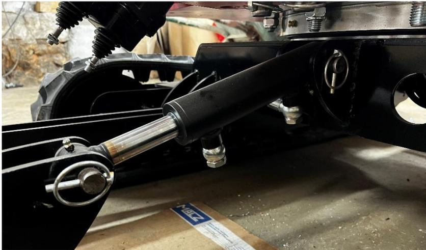
*Monter le vérin de lame dans le châssis
