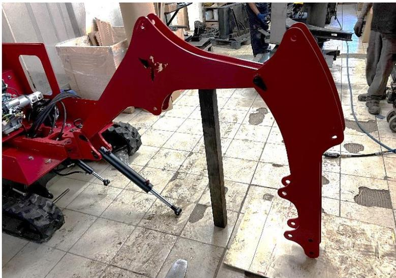
Monter les graisseurs dans le bras de balancier puis le mettre en place
