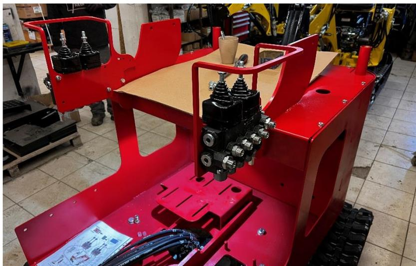
Monter les 2 distributeurs hydrauliques.
