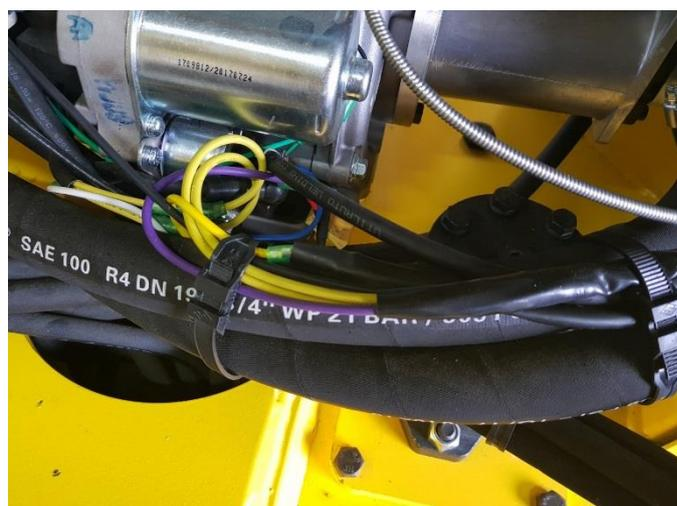
Brancher ensuite la seconde borne à l'un des fils jaunes en sortie de moteur Kohler (les 2 fils sont les alimentations + en 12 Volt).
