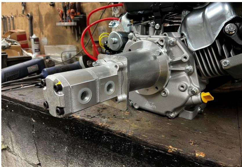
Placer la pompe sur la lanterne avec les 4 vis BTR de 6x25 coller une des vis afin que l'ensemble ne se desserre pas avec les vibrations.
