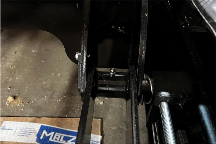
Monter 2 graisseurs M6 droit de chaque côté de la lame stabilisatrice.
