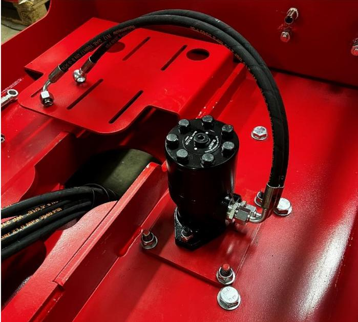
Positionner le moteur hydraulique, faites attention à ce que la dentelure soit bien enclenché.
