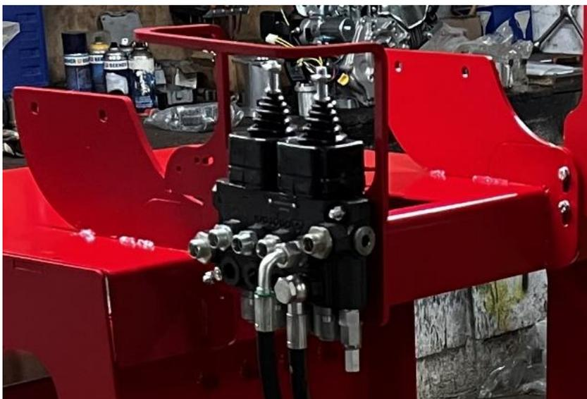
Monter les raccords sur les distributeurs hydrauliques.
