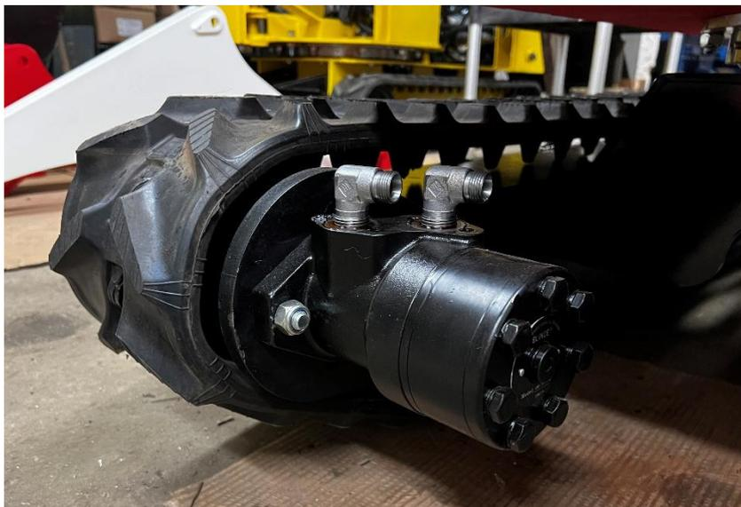
Monter 2 coudes ½ - 12L par moteur hydraulique, étanchéifier le coude avec du téflon au niveau du moteur hydraulique.
