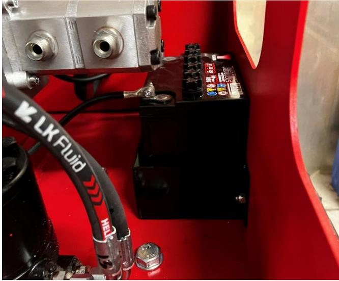
Monter la batterie et le support batterie en place.
