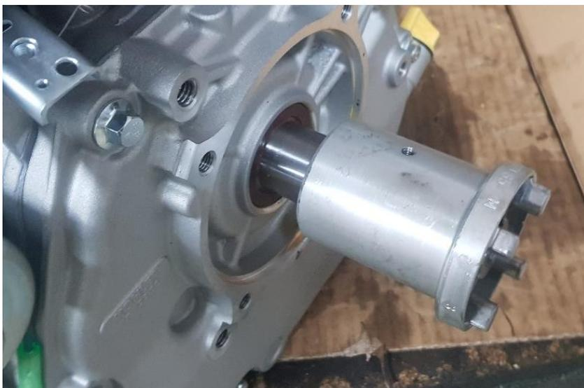
Remonter la clavette sur l'arbre moteur puis emboîter l'accouplement côté moteur en buté sur l'arbre moteur.
