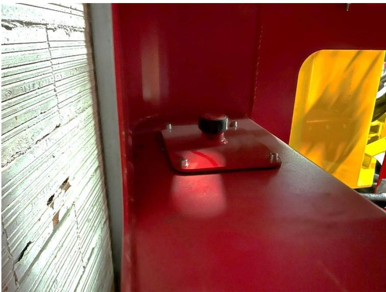
Remplir le réservoir d'huile hydraulique et monter la plaque réservoir avec 4 vis (le niveau sera à refaire après le premier démarrage).
