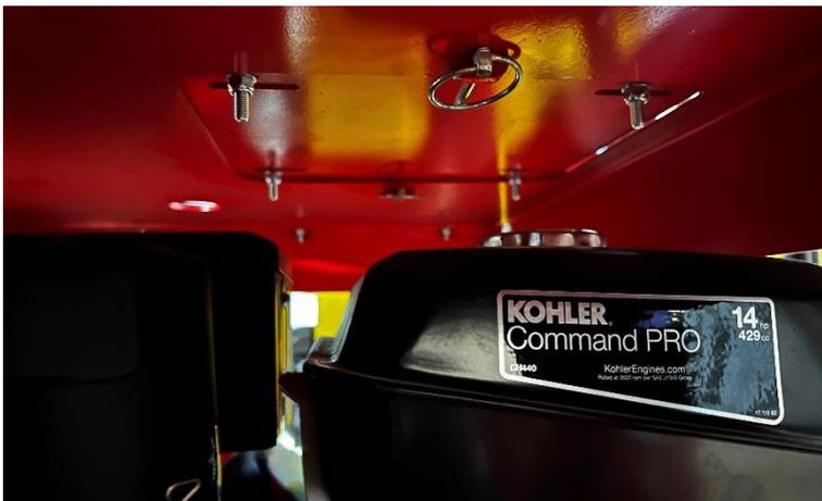
Monter le siège à travers les mortaises présentes sur la tourelle et mettre 2 goupilles pour le maintenir en place.
