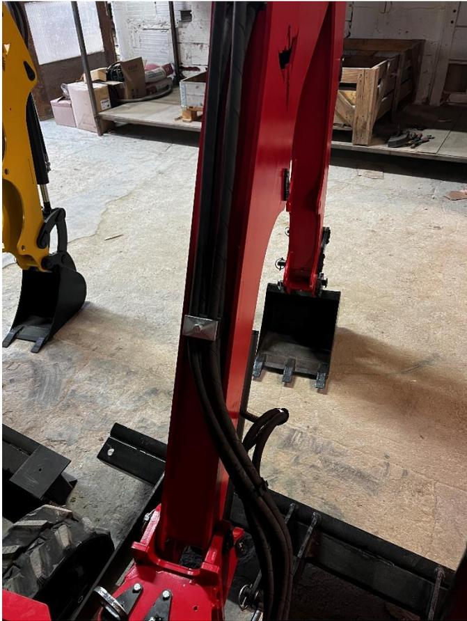
Monter le guide flexible dans le bras pour le maintien des flexibles.
