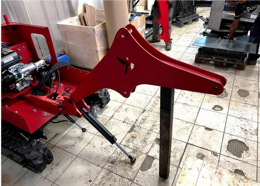
Monter les graisseurs dans le bras de levée puis monter celui-ci dans la noix
