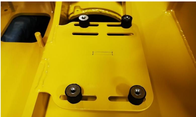
Monter les 4 silentbloc avec 1 rondelle
