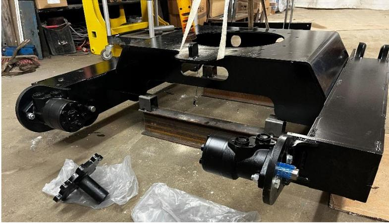
Monter 2 moteurs hydrauliques **OMR 200** sur le châssis avec 2 vis M12x50 et 2 écrous frein par moteur.
