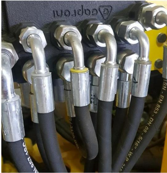
Une ligne n'est pas utilisée de série, celle-ci est obstruée avec un court flexible mit en bypass.
