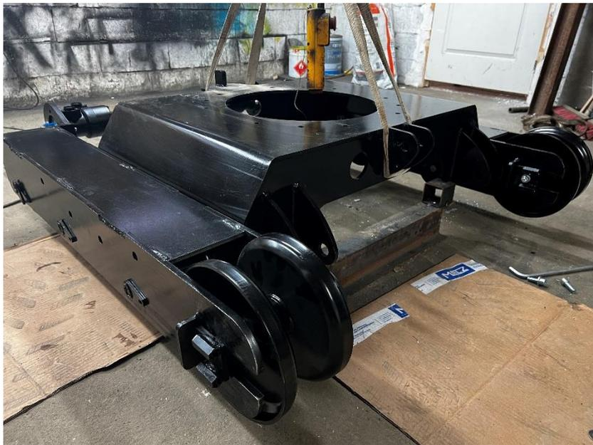
Mettre en place les 6 rollers Ø160 - 25 avec 6 axes Ø25 lg 175 + goutte d'eau dans les 2 côtés des trains de chenilles. Caller les rollers avec des bagues de Ø25 lg 25 de chaque côté.
