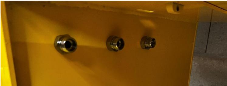
Monter les raccords union sur les retours réservoir en passe cloison avec une bague BS17 + écrou 3/8 dans le réservoir.
