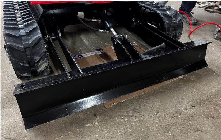
Monter la lame sur châssis avec 2 axes  $\varnothing 25$  lg 110 + GE.
