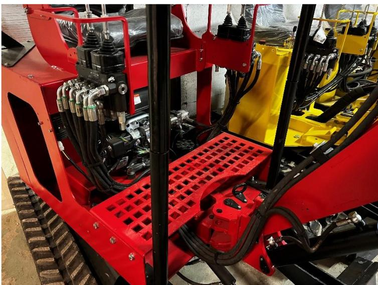
Vérifier le serrage des flexibles puis démarrer la machine à régime moyen.
