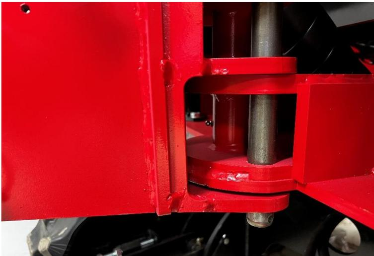
Monter le graisseur sur la bague du porte noix avant de monter la noix.
