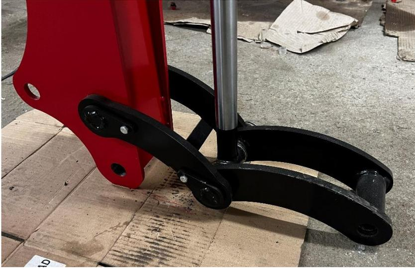
Monter le graisseur sur le renvoi de godet puis mettre les renvois sur le bras de balancier.
