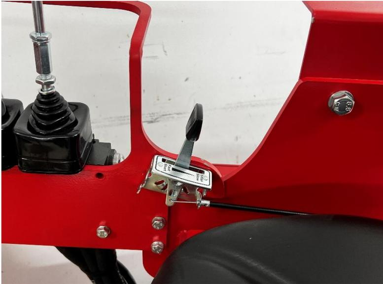
Monter l'accélérateur sur le support distributeur droit et faire passer la gaine dans le trou oblong à côté du réservoir.
