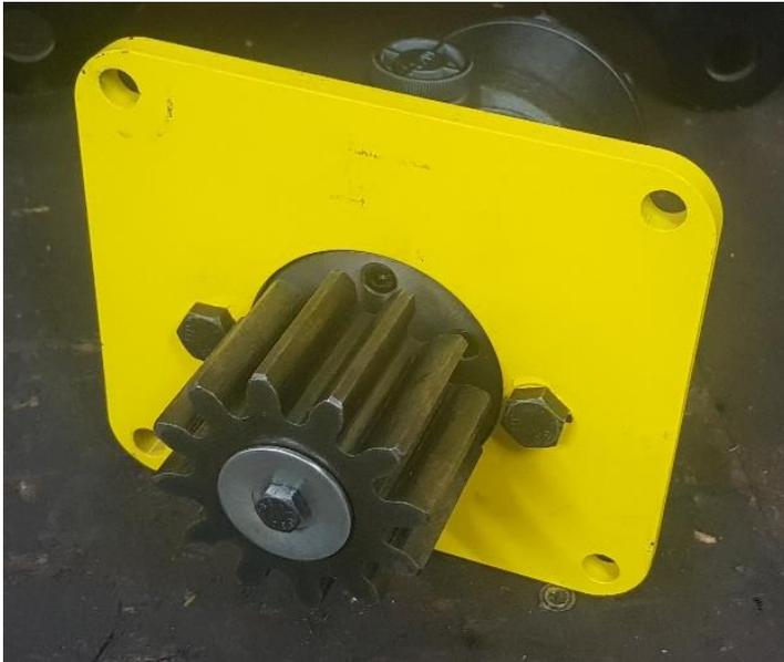
Monter le pignon sur le moteur hydraulique puis le verrouiller avec une vis de 8x50 + rondelle large.
