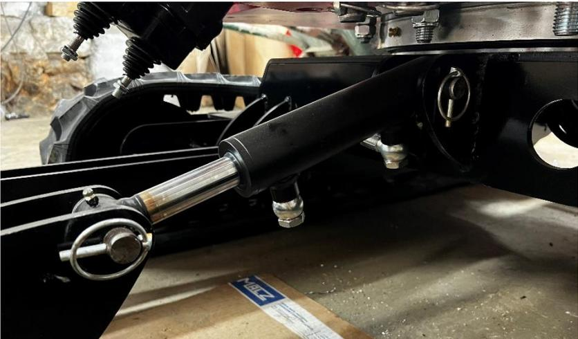
Monter les flexibles sur le vérin de la lame
