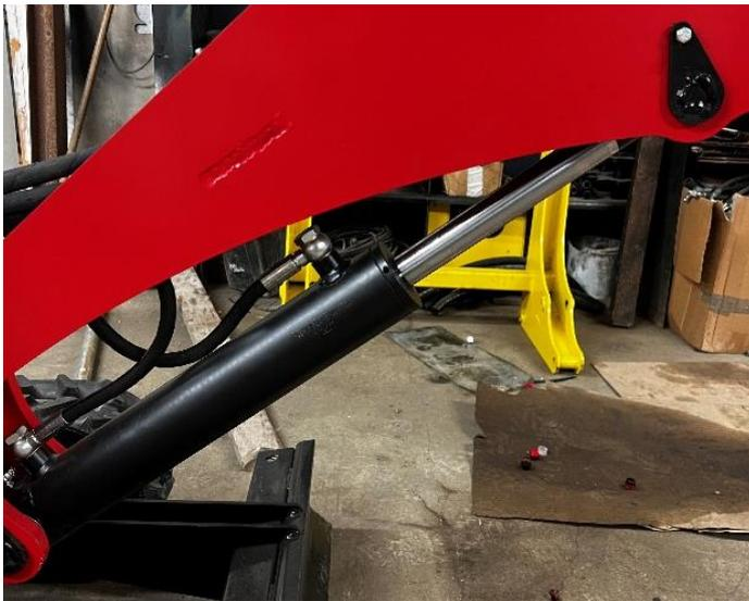
Monter les flexibles du vérin de levée, les flexibles se montent en vis creuse dans les bossages sur le vérin.
