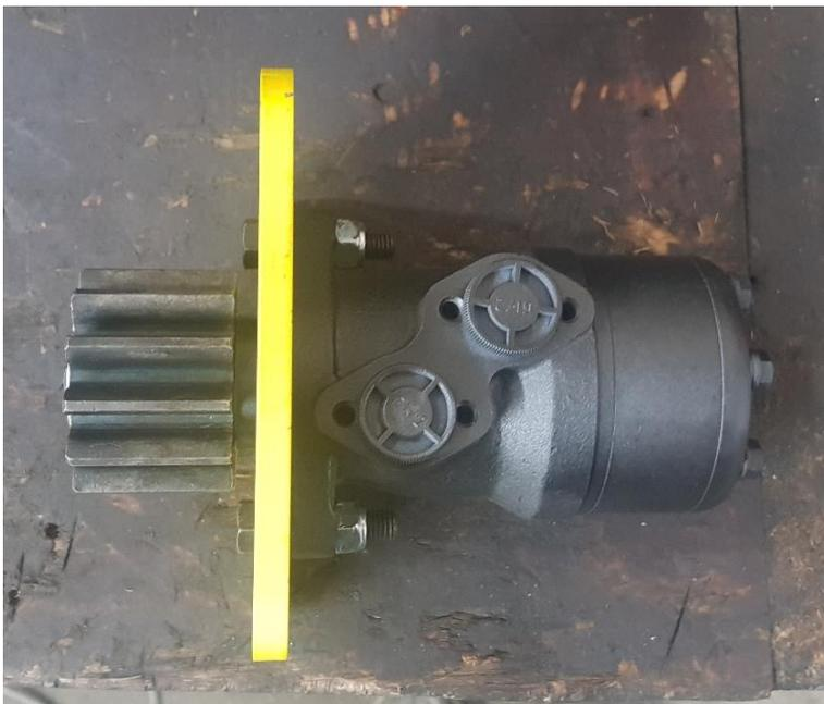
Monter le moteur hydraulique sur la plaque de rotation tourelle
