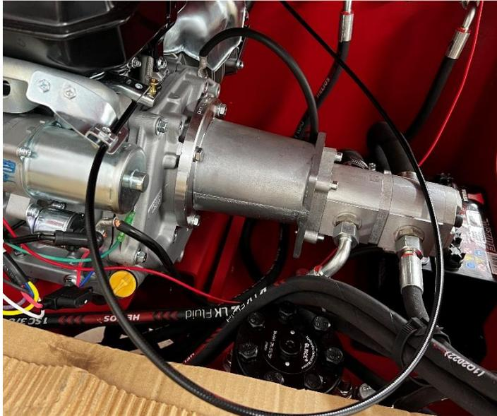
Faire passer le câble dans le guide en faisant une boucle suffisamment large pour que le câble ne force pas à l'usage.
