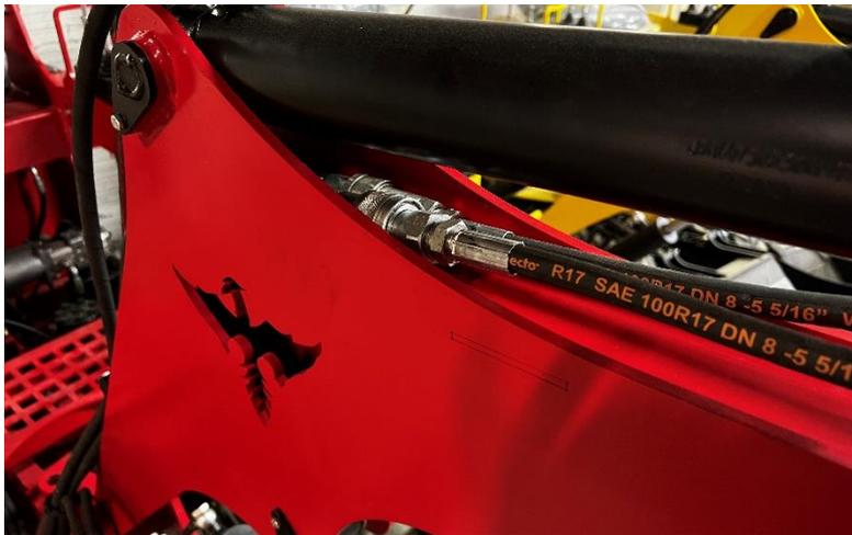
Visser les Raccords rapides sur les flexibles avec du ruban téflon et bien les verrouiller.
