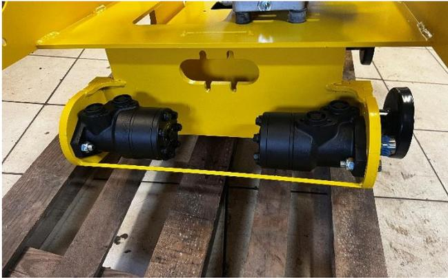
Monter le moteur hydraulique OMR200 sur le châssis des 2 cotés avec des vis de M12x50TH + écrou M12 frein.
