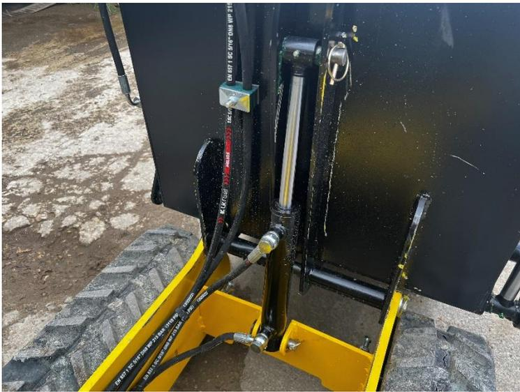
Monter les flexibles du vérin de la cuve.
