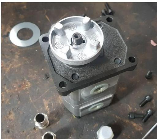
Défaire l'écrou et la rondelle de la pompe puis monter le demi-accouplement coté pompe, faire bien attention à ce que la clavette reste en place lors du montage. Avec une calle de bois poser sur la partie alu et un marteau, taper légèrement sur l'accouplement pour que celui-ci soit bien enfoncer sur l'arbre conique de la pompe.
