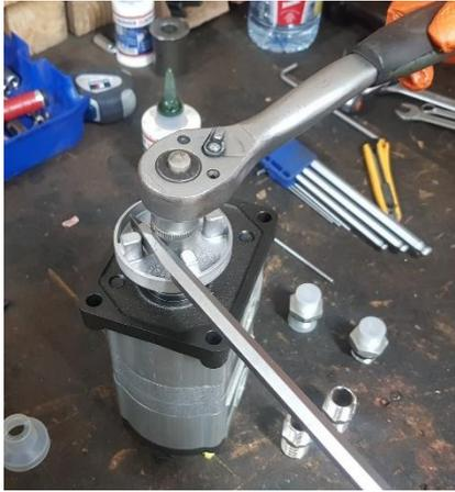
Monter la rondelle (attention à bien mettre le cran dans la rainure clavette) et l'écrou sur l'arbre de la pompe.
