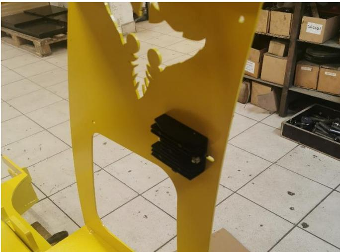
Monter et connecter le régulateur de charge du moteur.
