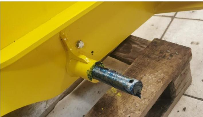
Monter les axes 4 Ø25 lg 175 + GE sur le châssis en les verrouillant avec des vis M6x16 + frein filet.
