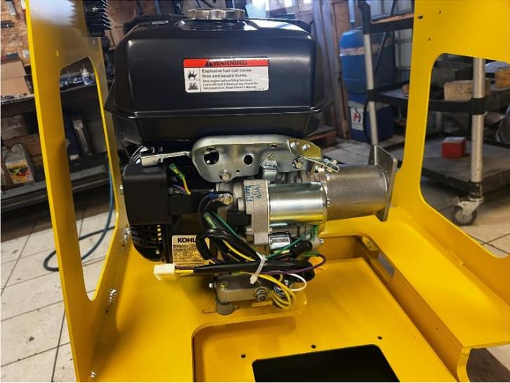
Monter ensuite le moteur sur le châssis avec 4 silentblocs.
