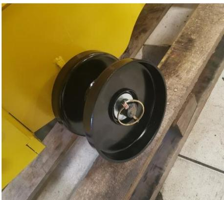
Monter les rollers Ø25 – 160 sur les axes préalablement graisser.
