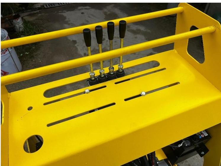
Monter le distributeur sur le dumper avec des vis de 8x70 + écrous freins et rondelles.
