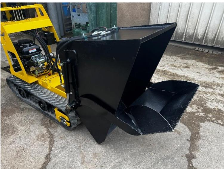
Faire le tour de la machine, pour y mettre les graisseurs, chaque axe doit avoir un graisseur.
