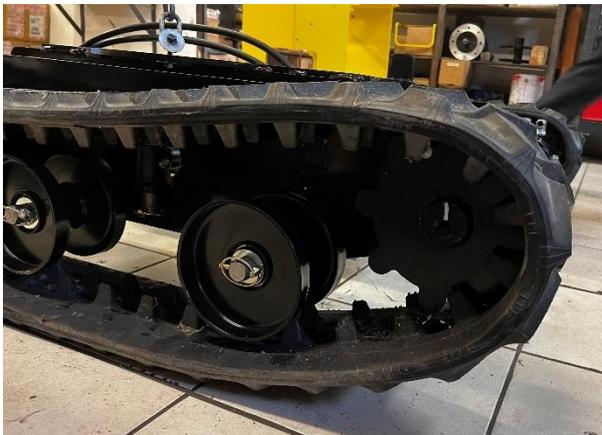
Mettre le barbotin dans la chenille puis emboîter l'ensemble sur le moteur hydraulique.
