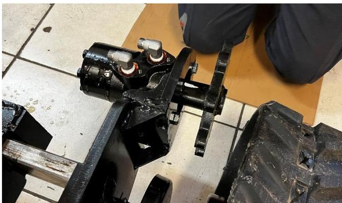
Avant de continuer le montage, mettre une noix de graisse sur l'arbre moteur puis essayer de monter le barbotin et faire tourner le moteur sur 1 tour complet afin de le débloquer.
