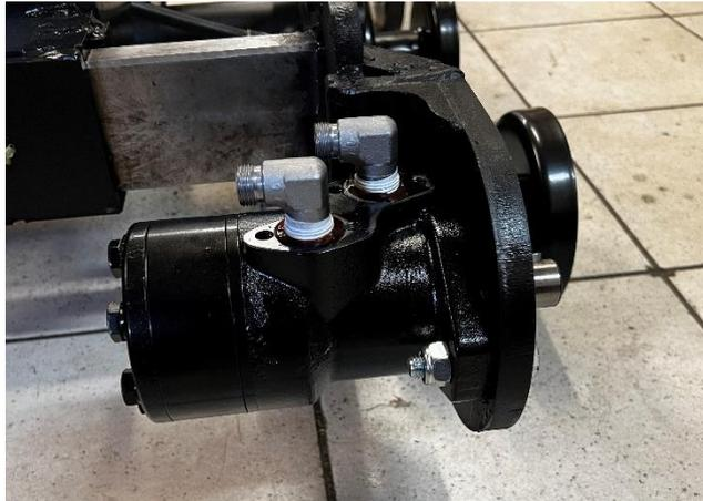
Monter les 2 coudes CM12L-15x21 sur chaque moteur hydraulique avec de la colle hydraulique ou du ruban téflon
