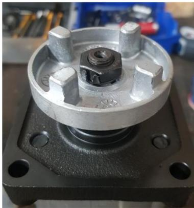
Une fois l'écrou verrouiller, à l'aide d'un tournevis plat, rabattre les 2 languettes de la rondelle sur l'écrou pour verrouiller celui-ci.
