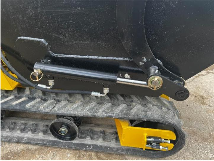
Monter le godet autochargeur sur le dumper avec ses 2 vérins.
