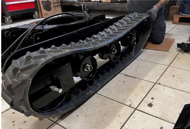
Monter la chenille sur le châssis depuis l'avant vers l'arrière pour que le roller reste dans son emplacement
