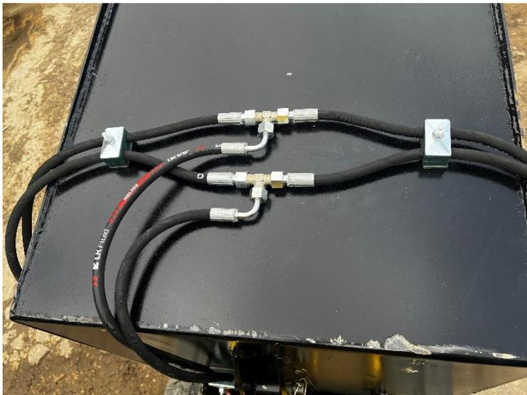
Monter les Tés avec les vis souder sur la cuve puis monter les flexibles en suivant le schéma hydraulique.
