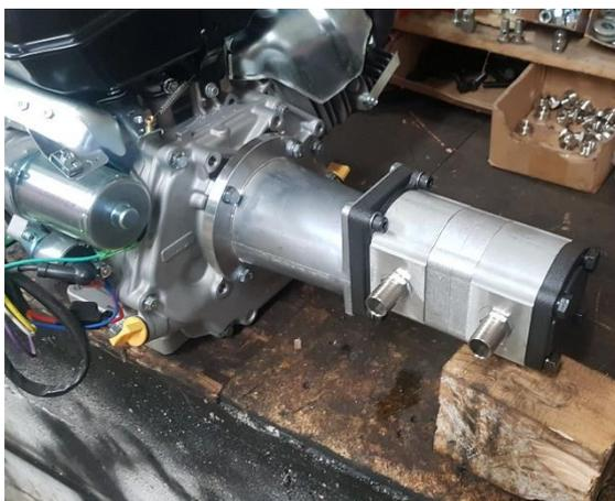
Monter les raccords sur la pompe, embout cannelé + téflon d'un coter et UM12L-15x21 de l'autre (pas besoin de téflon celui-ci possède un joint)
