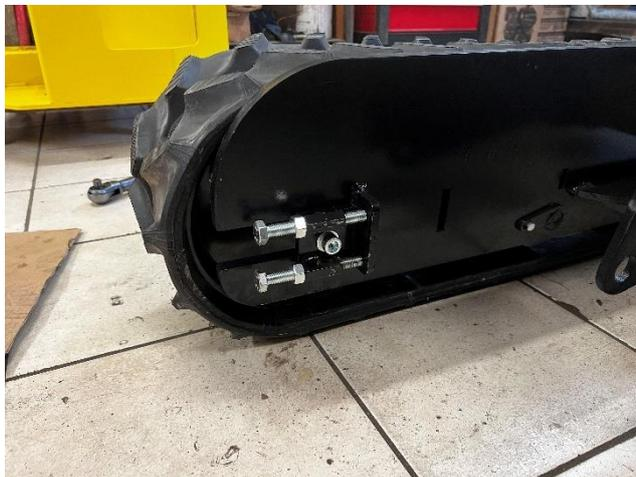
Une fois les tendeurs en place, monter les boulons de tension M12x100 + contre écrou, 2 par demi-tendeurs et tendre légèrement la chenille.
