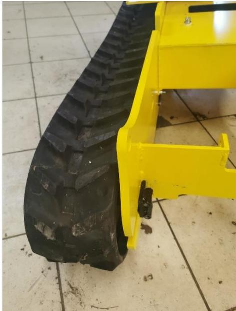
Monter les deux demi-tendeurs sur le roller avant, le demi-tendeurs le plus court à l'extérieur du châssis.
