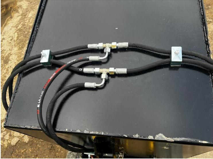
Monter les guides flexibles sur la machine,
