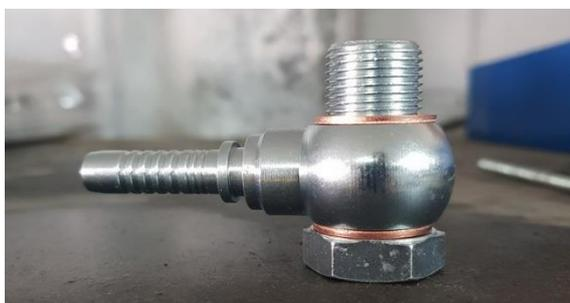
Les vis Banjo se montent avec 2 rondelles cuivre ou BS, une au-dessus et une en dessous de la vis.
