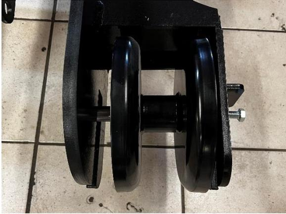
Monter le roller avec son axe dans la partie tendeur, sans les deux demi-tendeurs.
