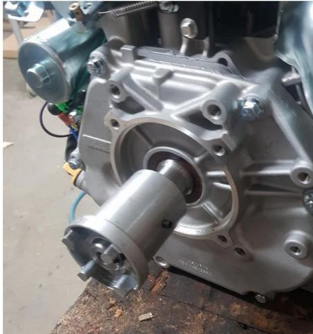
Monter le demi-accouplement en butée sur le moteur, avec une vis de pression sans tête M6x10.
