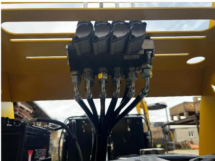
Monter les flexibles d'alimentation des moteurs hydraulique en suivant le schéma de flexible.
