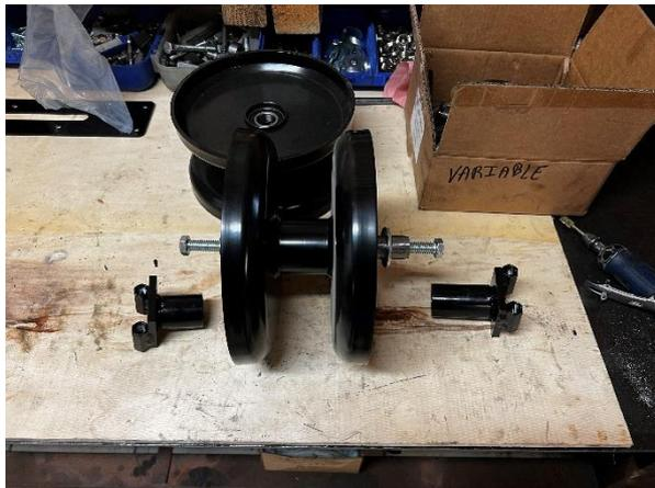
Préparer les tendeurs, essayer de monter les deux demi-tendeurs et les vis M12x50 de chaque côté, au besoin agrandir un peu le perçage des demi-tendeurs pour faciliter le montage de la vis.
