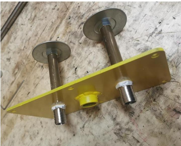
Préparation de la plaque réservoir, pour le montage en pompe simple une seule crépine est nécessaire, le second trou sera obstrué avec une vis écrou + rondelle.
