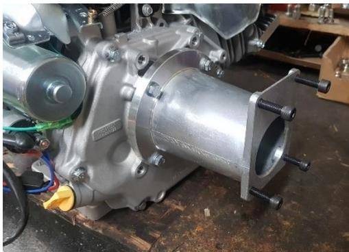
Monter la lanterne sur le moteur avec les 4 vis pas fin prévue pour le moteur Kohler. Ne pas serrer les vis trop fort, le carter est en aluminium.
