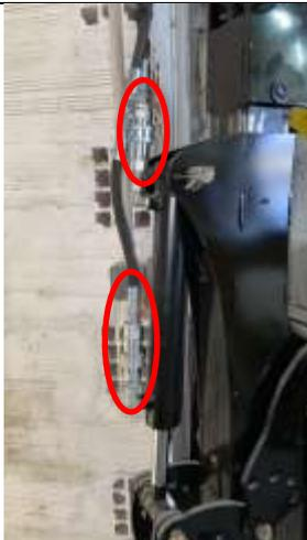
Désaccoupler les raccords rapides et les rebrancher sur les raccords de la tarière
