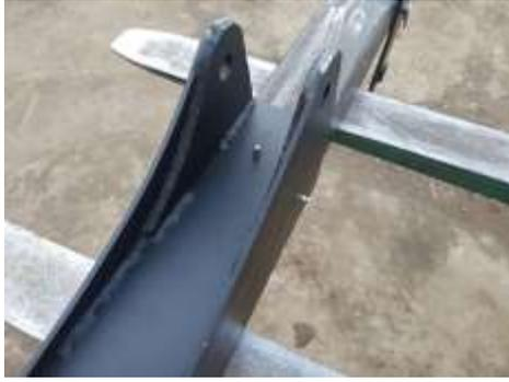
Placer les graisseurs et verrouiller les axes du vérin avec les gouttes d'eau.
