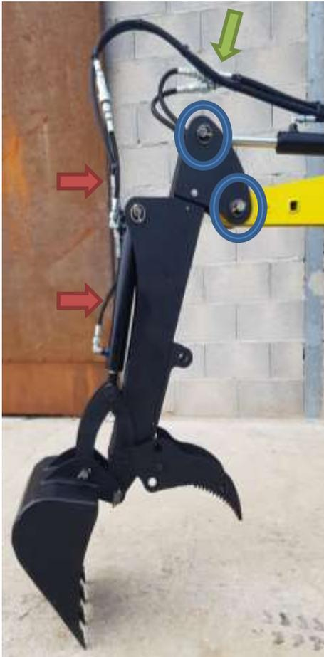
Monter le bras sur la pelle en lieu et place du bras de balancier (axes en bleu).
